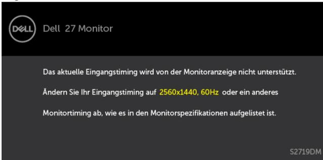
Das bedeutet, dass sich der Monitor mit dem vom Computer empfangenen Signal nicht synchronisieren kann. Siehe [Technische Daten des Monitors](#) für die horizontalen und vertikalen Frequenzbereiche, die für diesen Monitor adressierbar sind. Empfohlener Modus ist 2560 x 1440.
