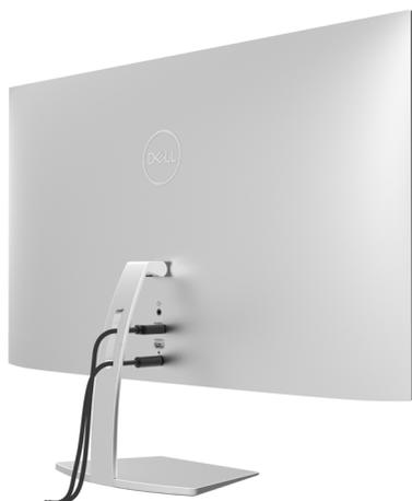
Nakon pričvršćivanja svih potrebnih kabela na monitor i računalo, (pogledajte [Connecting Your Monitor \(Povezivanje monitora\)](#) za pričvršćivanje kabela) organizirajte sve kabele kao što je prethodno prikazano.
