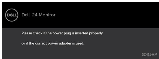
في حالة تحديد دخل HDMI1 و HDMI2 وعدم توصيل الكبل المناظر، سيظهر مرربع الحوار المتحرك كما هو موضح أدناه.
