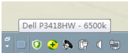
**NOTA:** El administrador de pantallas de Dell necesita utilizar el canal DDC/CI para comunicarse con el monitor. Asegúrese de que la funcionalidad DDC/CI se está habilitada en el menú tal y como se muestra a continuación.
