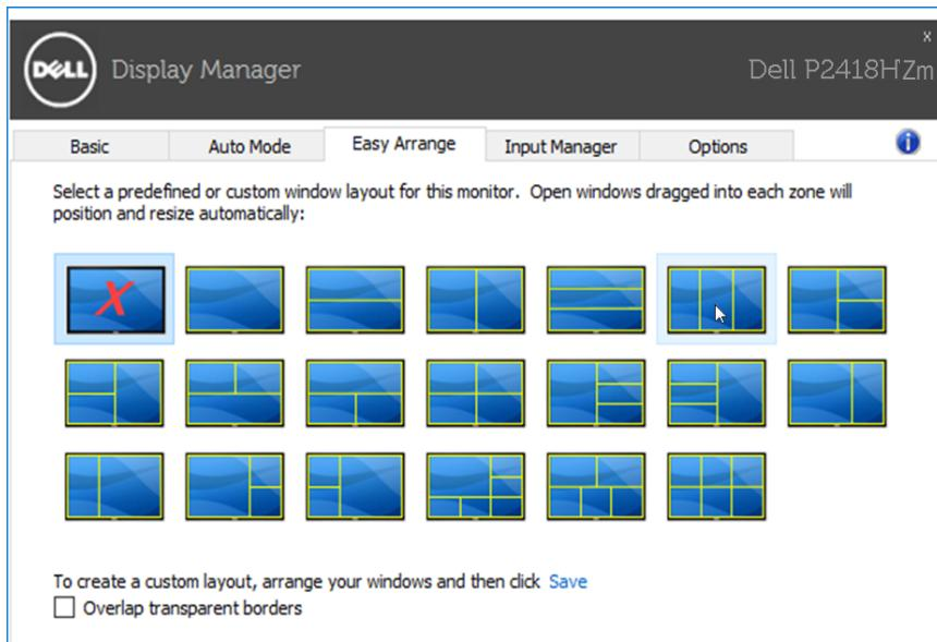
Để tạo kiểu bố trí cửa sổ tùy chỉnh, hãy định kích thước và bố trí các cửa sổ (tối đa 10 cửa sổ) trên màn hình nền rồi nhấp liên kết **Save (Lưu)** trong **Easy Arrange (Sắp xếp đơn giản)**. Kích thước và vị trí của các cửa sổ được lưu dưới dạng kiểu bố trí tùy chỉnh và biểu tượng kiểu bố trí tùy chỉnh này sẽ được tạo ra.
