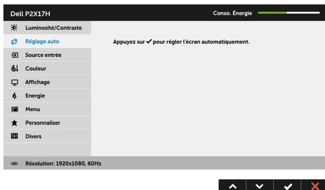
Le **Réglage auto** permet au moniteur de s'adapter automatiquement au signal vidéo entrant. Après avoir utilisé la fonction **Réglage auto**, le réglage du moniteur peut être retouché en utilisant les commandes d'**Horloge pixel** (grossier) et de **Phase** (fin) sous les paramètres d'**Affichage**.
