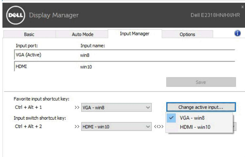
**LƯU Ý:** DDM kết nối với màn hình của bạn ngay cả khi màn hình đang hiển thị video từ một máy tính khác. Bạn có thể cài đặt DDM vào máy tính thường dùng và điều khiển cách chuyển đổi đầu vào từ máy tính đó. Bạn cũng có thể cài đặt DDM vào các máy tính khác đã kết nối với màn hình.
