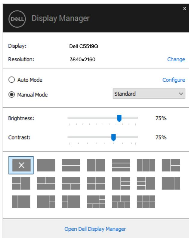
Диалоговият прозорец **Quick Settings** (**Бързи настройки**) има достъп до разширения потребителски интерфейс на Dell Display Manager, който се използва за регулиране на основни функции, конфигуриране на Auto Mode (**Автоматичен режим**) и достъп до други функции.
