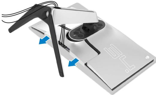
5. Lepaskan kabel dari monitor dan geser kabel melalui slot manajemen kabel di kaki penyangga.
