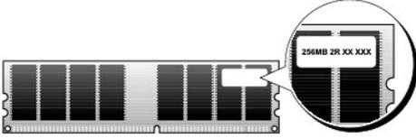
**ANMERKUNG:** Installieren Sie Speichermodule immer in der auf der Systemplatine angegebenen Reihenfolge.
