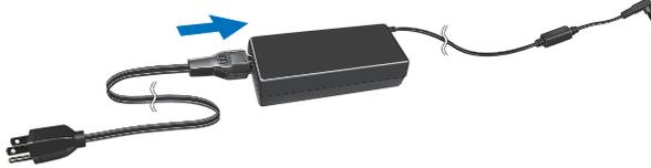
2 قم بتوصيل مهايئ التيار الكهربائي بالكمبيوتر.
