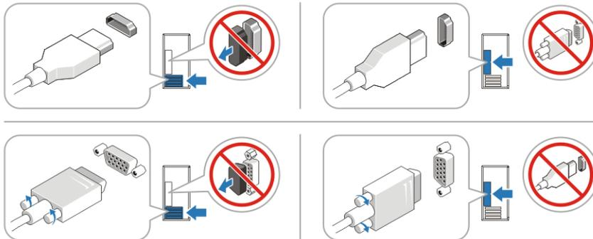
그림 5. VGA 커넥터 및 HDMI 커넥터
