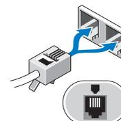
**3** Se si è acquistata la scheda grafica opzionale, collegare il display al connettore sulla scheda grafica discreta. Altrimenti, collegare il display utilizzando il connettore integrato VGA o HDMI. Collegare il monitor utilizzando solo uno dei seguenti cavi.
