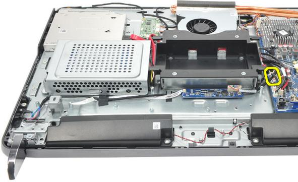
7. Dégagez le câble des clips du châssis et retirez l'ensemble interrupteur d'alimentation.
