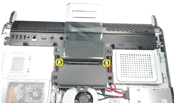
4. Poussez le socle arrière à l'intérieur et vers le haut et sortez-le du châssis.
