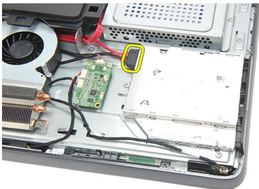
4. Retirez la vis de fixation du lecteur optique au châssis.
