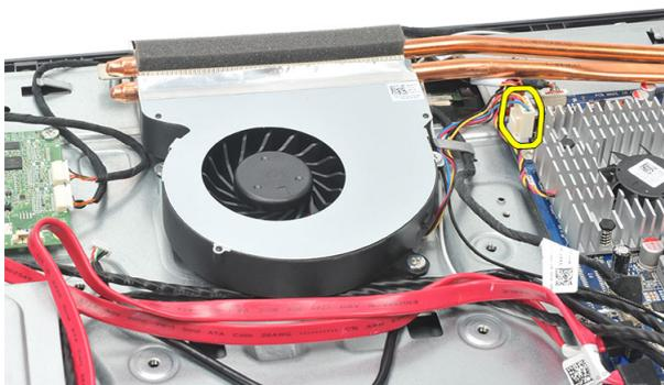
8. Retirez les vis de fixation du ventilateur de l'UC au châssis.
