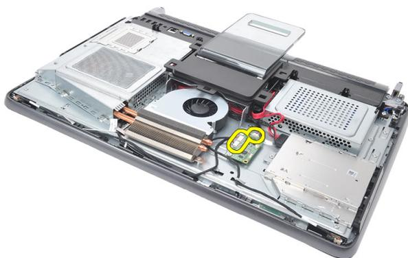
4. Retirez les vis de fixation de la carte du contrôle tactile.
