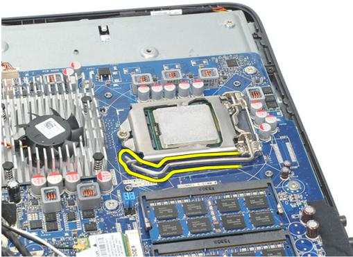
10. Soulevez le cache du processeur et retirez le processeur du connecteur. Placez-le dans un sachet antistatique.
