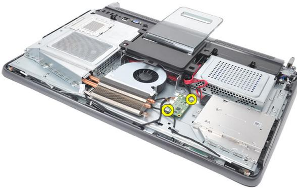
5. Soulevez la carte du contrôle tactile du châssis en la soulevant.
