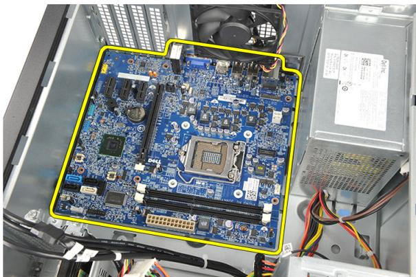
6. Levante a placa de sistema, removendo-a do chassis do computador, e coloque-a numa embalagem antiestática.
