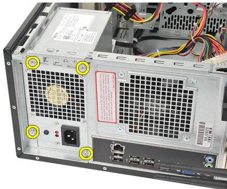
5. Prima o botão de libertação localizado no fundo do chassis do computador e, em seguida, faça deslizar a fonte de alimentação em direcção à parte frontal do computador.
