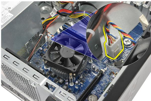
4. Desaperte os parafusos integrados que fixam o conjunto do dissipador de calor/ventoinha à placa de sistema.
