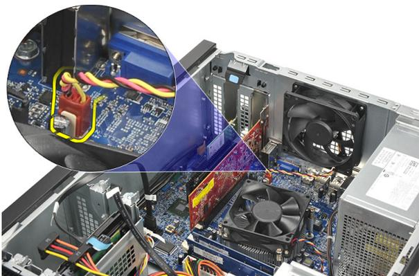
4. Retire os parafusos que fixam a ventoinha à parte posterior do computador.
