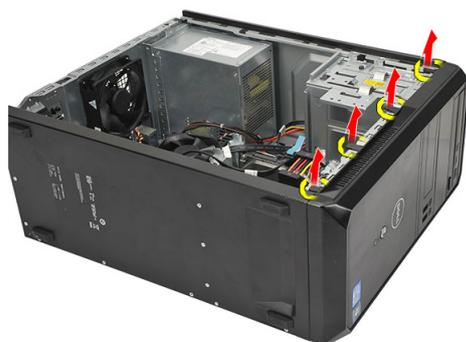
4. Rode e remova a moldura do computador para soltar do chassis os ganchos existentes na extremidade oposta da moldura.
