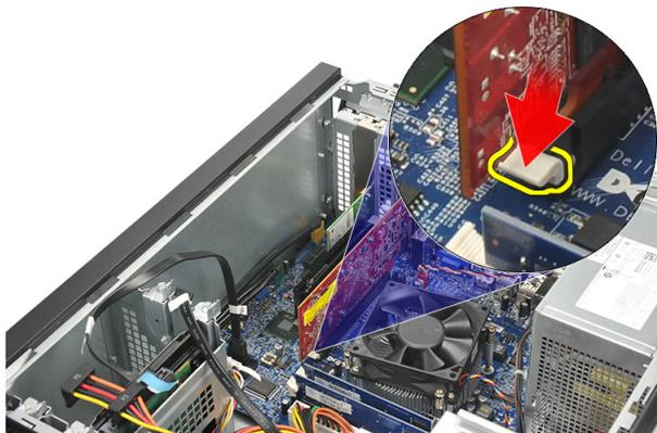
5. Solte e levante a placa do respectivo conector e remova-a do computador.
