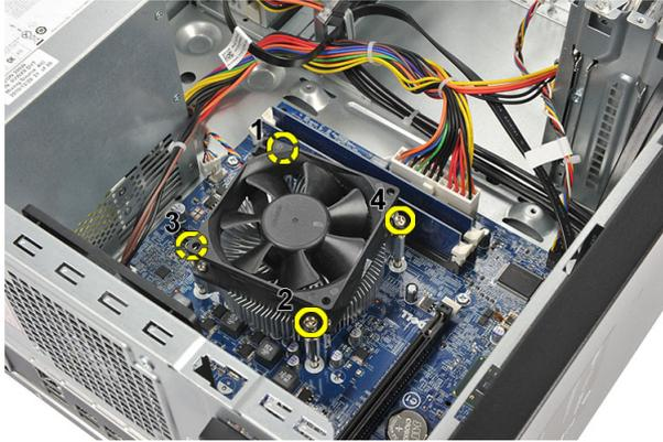
5. Levante o conjunto do dissipador de calor/ventoinha e remova-o do computador.
