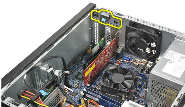
4. Pressione a alavanca de libertação para soltar a presilha de fixação do entalhe na placa.
