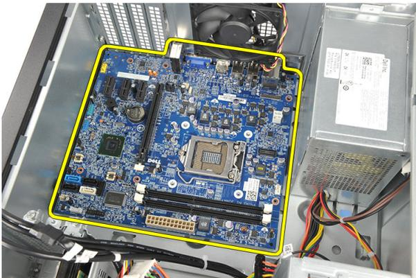
6. Soulevez la carte système pour la retirer du châssis et placez-la dans un emballage antistatique.
