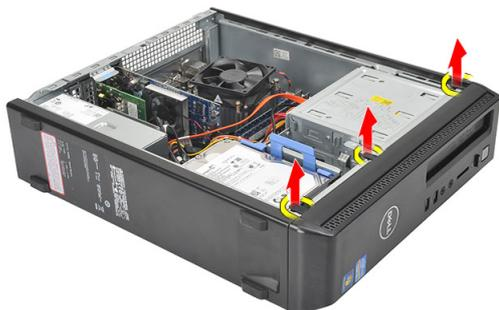
4. 朝远离计算机的方向转动前挡板，以松开机箱中挡板另一侧边缘上的挂钩。
