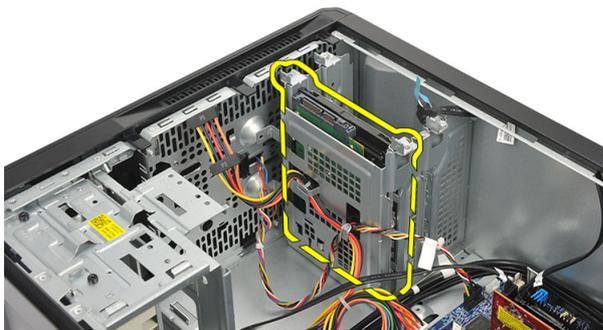
6. 拧下将支架固定至硬盘驱动器的螺钉。
