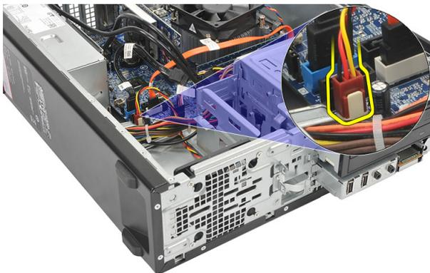
4. 拧下将风扇固定至计算机的螺钉。
