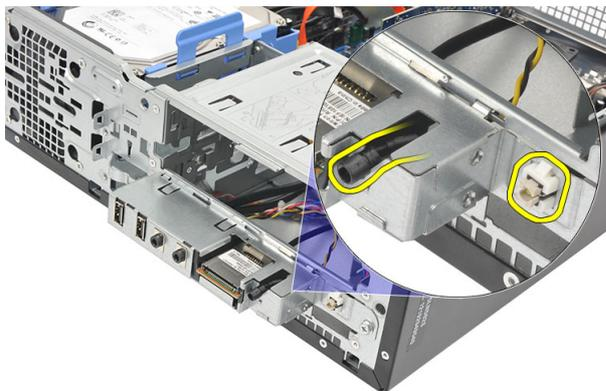
7. 拧下将 I/O 面板固定至计算机的螺钉。
