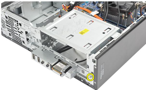
8. 将 I/O 面板朝计算机底部滑动，然后将 I/O 面板从计算机卸下。
