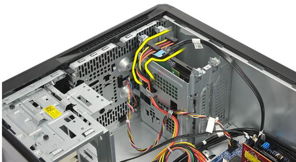
4. 拧下将硬盘驱动器固定至计算机的螺钉。
