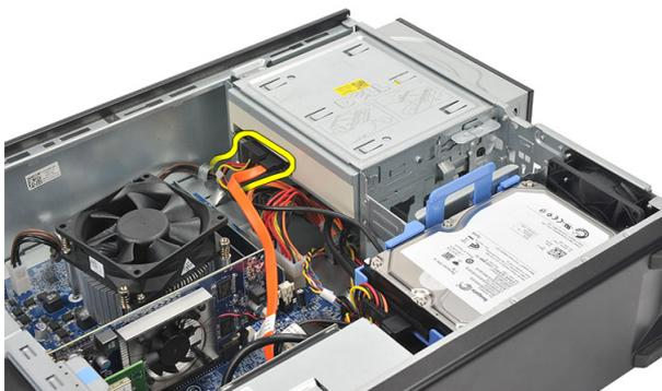
4. 拉动光盘驱动器释放门锁，然后朝计算机正面推动光盘驱动器。
