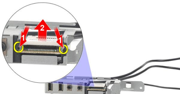
10. 将 SD 插卡读取器从 I/O 面板支架卸下。
