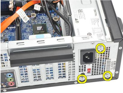
9. 向内按压电源设备旁边的蓝色释放卡舌，然后将电源设备朝计算机正面滑动。
