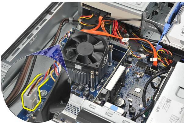
4. 拧松将散热器和风扇部件固定至系统板的固定螺钉。
