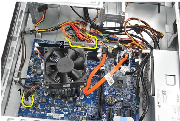
7. 将电源电缆从金属固定夹抽出。
