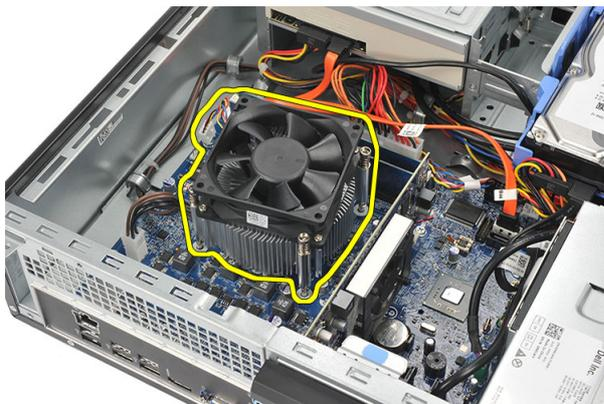
6. 向下按压释放拉杆，然后向外移动，从固定拉杆的固定挂钩上释放拉杆。
