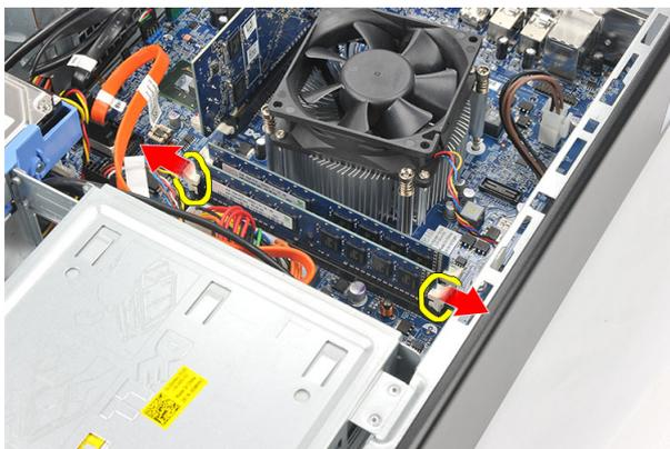
4. 将内存模块提离系统板上的连接器。
