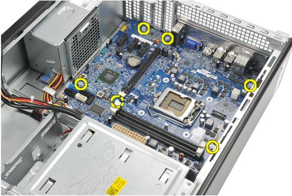
11. 将系统板向计算机正面滑动，然后小心地倾斜 45 度角。
