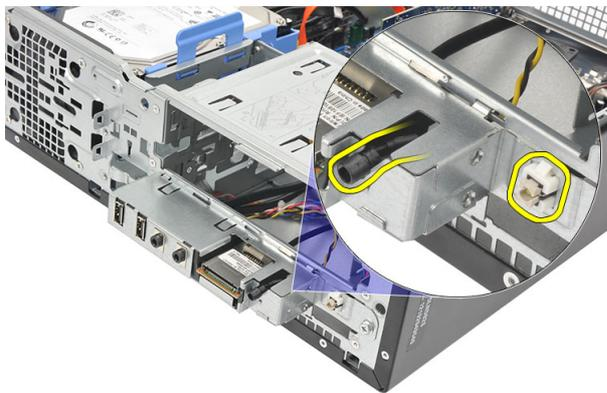
6. 将电源开关和硬盘驱动器 LED 电缆从计算机正面滑出。
