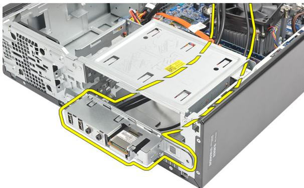
9. 使用小型平头螺丝刀释放固定夹，然后向上推动 SD 插卡读取器。
