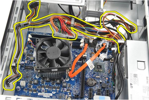
8. 拧下将电源设备固定至计算机的螺钉。
