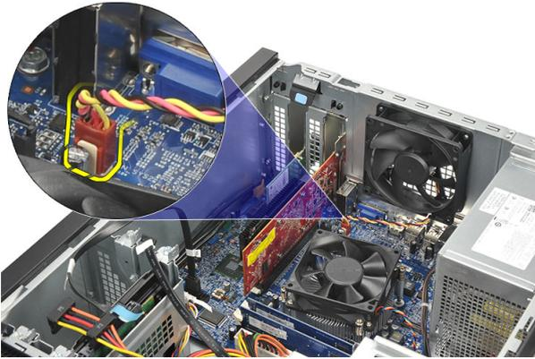
4. Extraiga los tornillos que fijan el ventilador al equipo.
