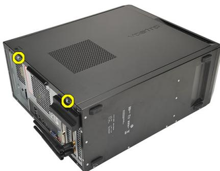
3. Deslice la cubierta hacia la parte posterior del equipo.
