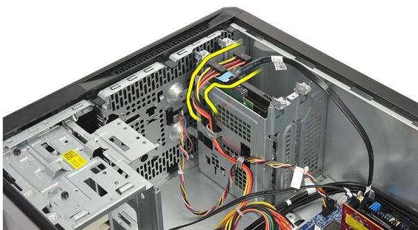
4. Extraiga los tornillos que fijan la unidad de disco duro al equipo.
