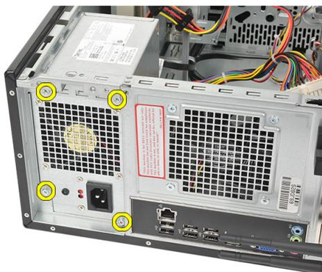
5. Presione el botón de liberación situado en la base del chasis del equipo y deslice la fuente de alimentación hacia la parte frontal del equipo.
