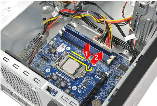
7. Levante la cubierta del procesador.
