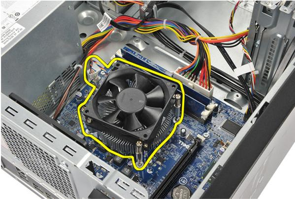
6. Presione la palanca de liberación para moverlo hacia afuera y extráigalo del gancho de retención.
