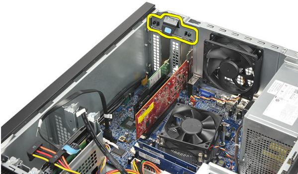
4. Presione la palanca de liberación para liberar la pestaña de seguridad de la muesca en la tarjeta.
