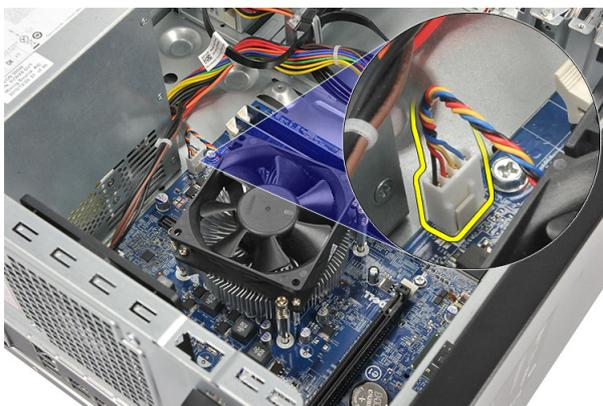
4. Afloje los tornillos cautivos que fijan el ensamblaje del disipador de calor y ventilador a la placa base.
