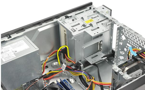
4. Extraiga los tornillos que fijan la unidad óptica al equipo.
