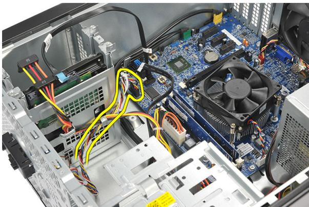
4. Desenganche y extraiga las pestañas que sujetan el interruptor de alimentación/ensamblaje de LEDs del equipo
