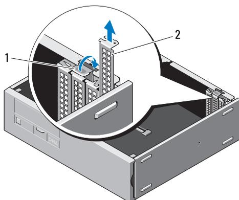
1 fermaglio di fissaggio della scheda PCI    2 pannello di riempimento dello slot schede PCI
