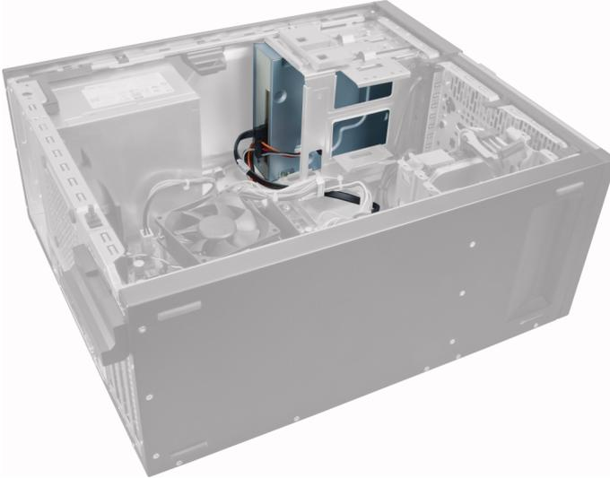
4. 从光盘驱动器后面卸下数据电缆和电源电缆。
