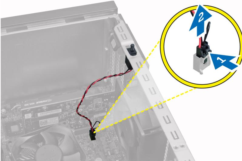
4. 将防盗开关滑向机箱底部，将其从计算机中卸下。
