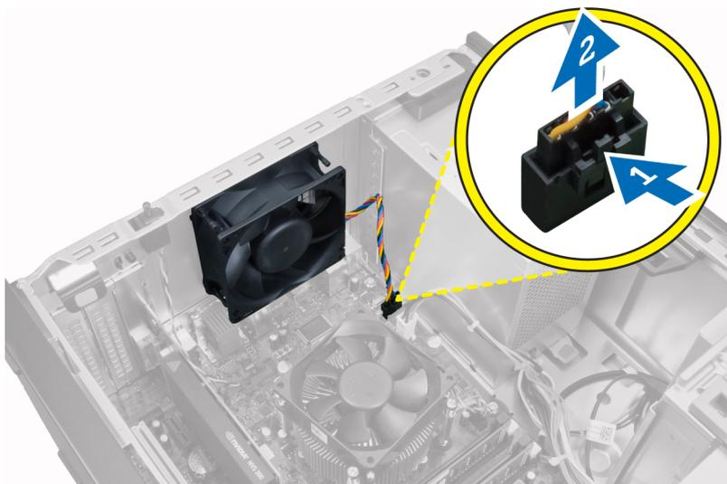
4. 撬开将系统风扇固定到计算机后面的四个索环，并将系统风扇卸下。
