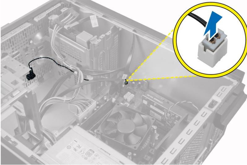
4. 将热感器电缆从机箱固定夹中松开。
