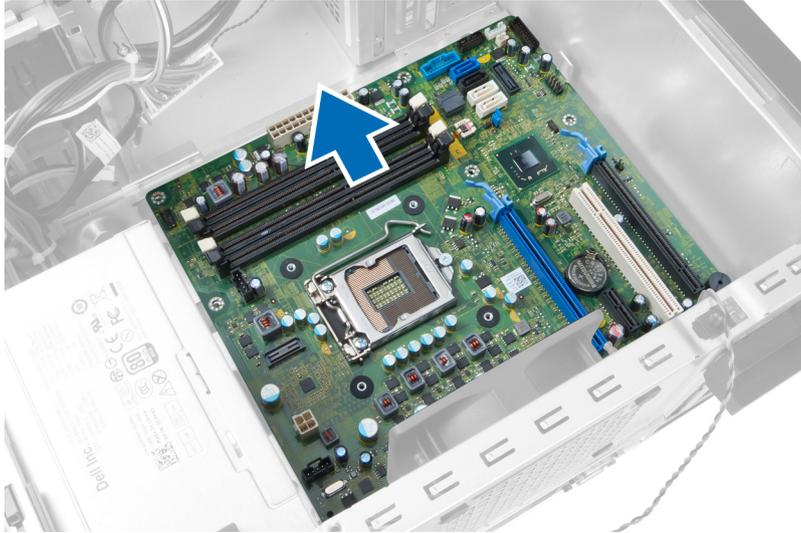
6. 将系统板小心倾斜 45 度，然后将系统板从计算机中提出。
