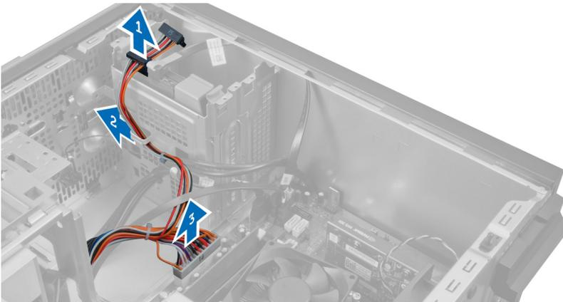
5. 断开 4 针电源电缆与系统板的连接。
