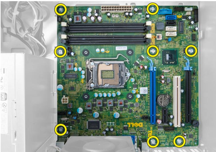
5. 将系统板向计算机正面滑动。
