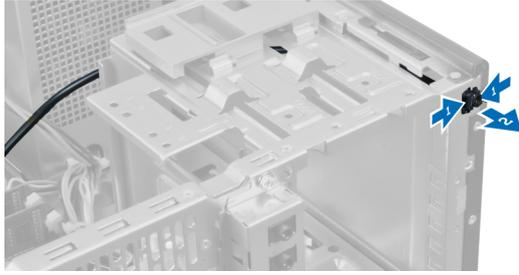
6. 将电源开关及其电缆从计算机正面滑出。
