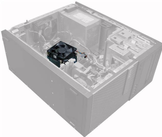
3. 按下塑料固定夹以释放并断开散热器电缆与系统板的连接。
