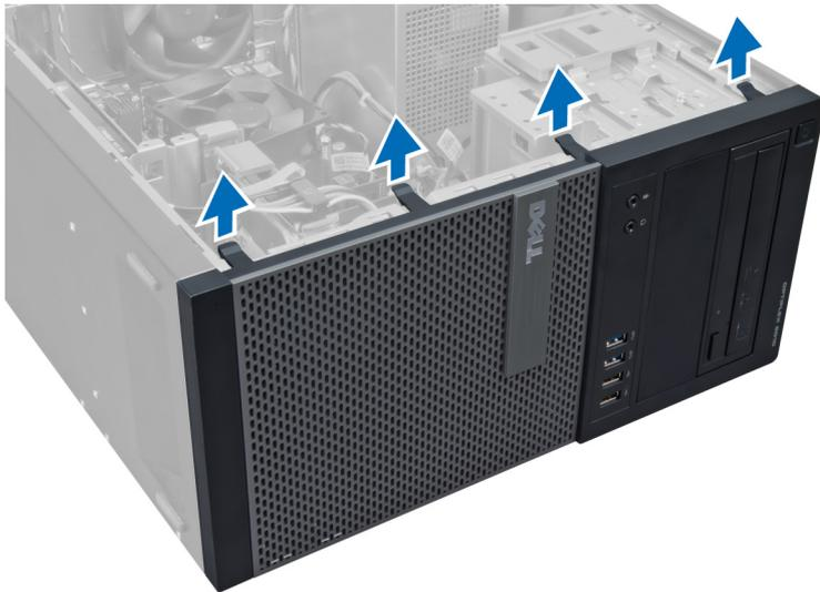
4. 朝远离计算机的方向转动前面板，以松开机箱中面板另一侧边缘上的挂钩。
