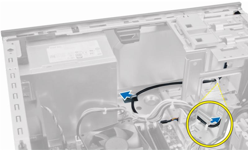
5. 按下电源开关两侧的固定夹，将其从机箱中松开，然后将电源开关拉出计算机。
