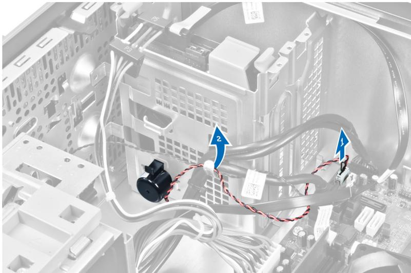
4. 向下按压扬声器固定卡舌，并将扬声器向上滑动使其卸下。
