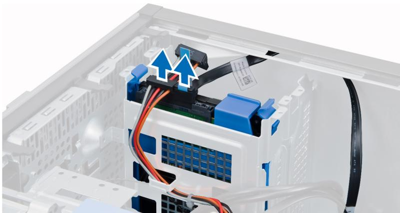
4. 向内按下两个蓝色固定支架卡舌，并将硬盘驱动器支架从托架中提出。
