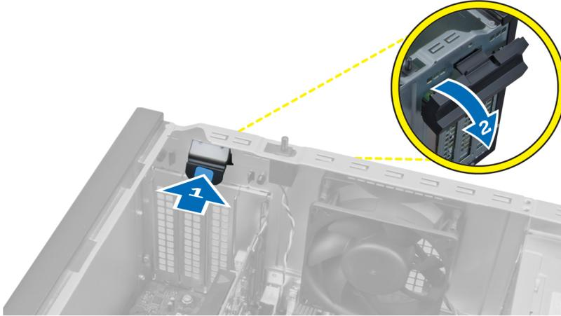
4. 将释放拉杆轻轻拉离 PCIe x16 插卡，直到将固定卡舌从插卡凹槽中释放出来。然后，从其连接器中提起插卡并将其从系统板中卸下。
