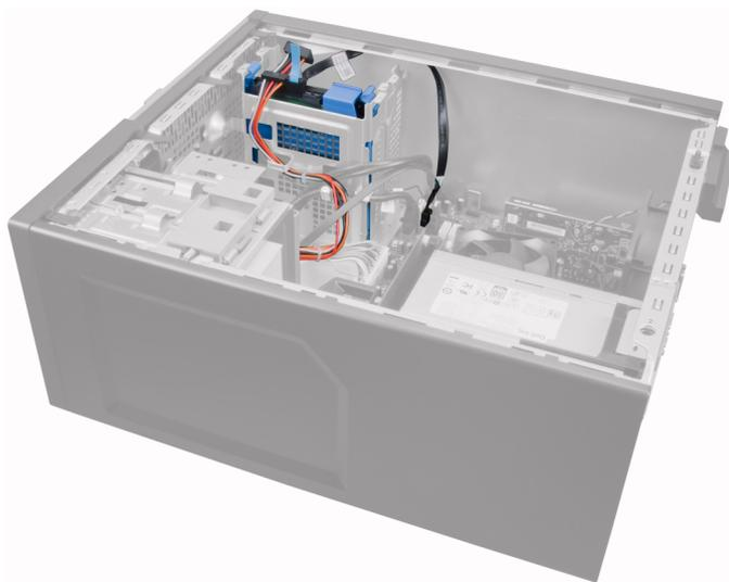
3. 从硬盘驱动器后面卸下数据电缆和电源电缆。
