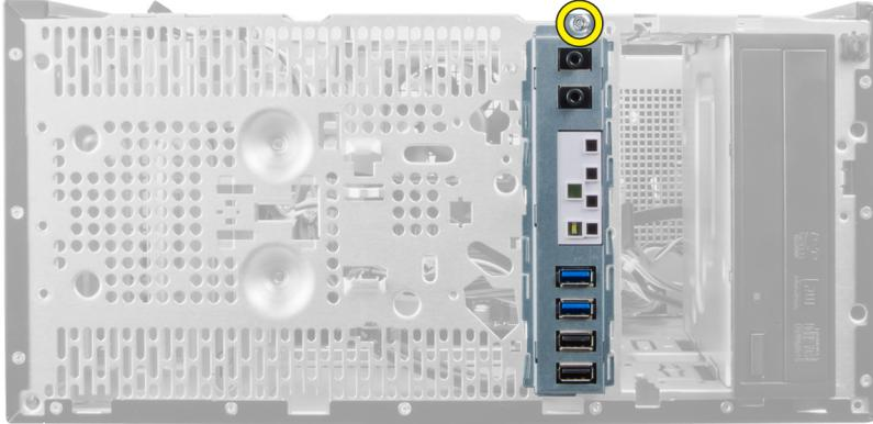
7. 将 I/O 面板向计算机左侧滑动以将其取下，然后将 I/O 面板与其电缆一起从计算机中拉出。
