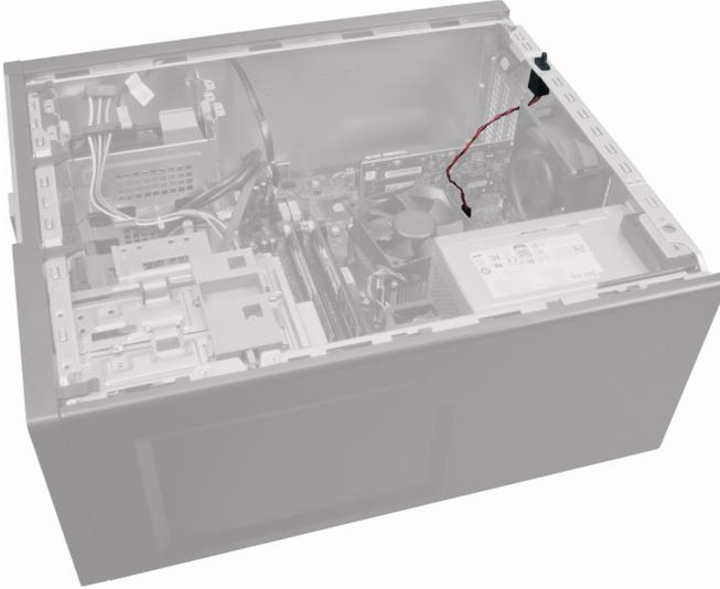
3. 向里按下固定夹，将其释放，将防盗开关电缆从系统板上拔下。
