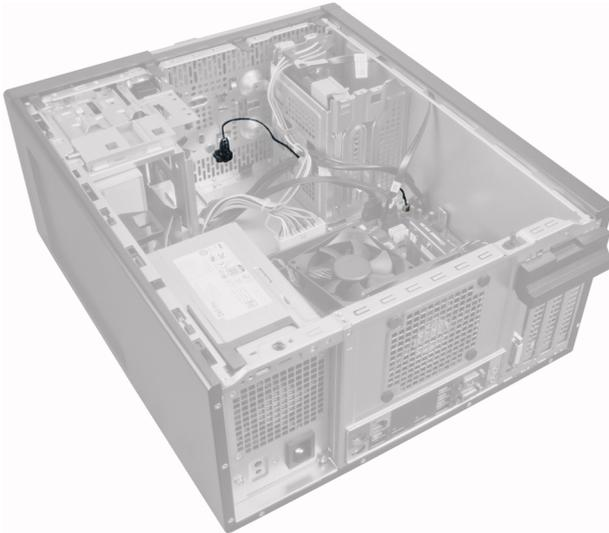
3. 断开热感器电缆与系统板的连接。
