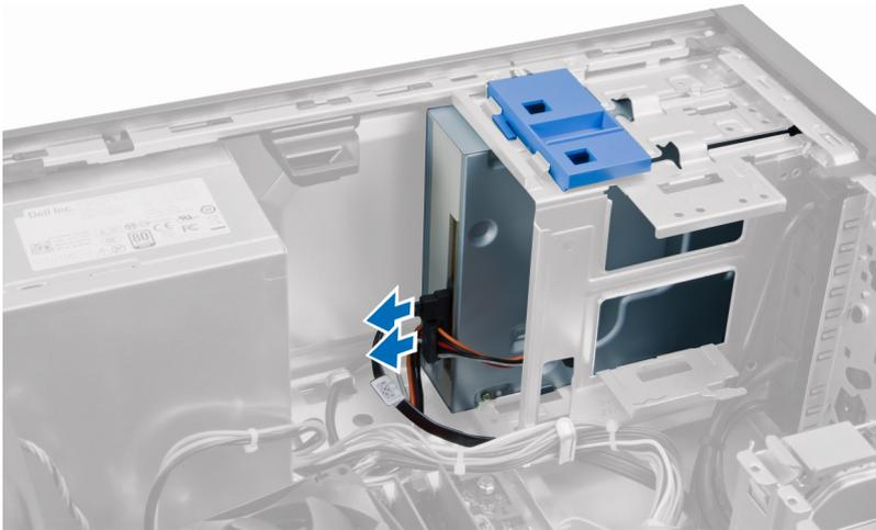
5. 滑下并握住光盘驱动器门锁，以将光盘驱动器解锁，然后将光盘驱动器拉出计算机。
