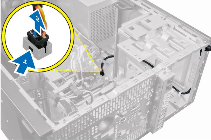
4. 将电源开关电缆从机箱固定夹中松开。
