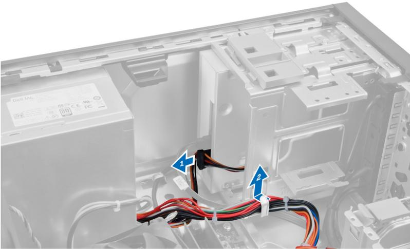
4. 断开电源电缆与硬盘驱动器的连接，并将其从固定夹中松开。断开 24 针电缆与系统板的连接。
