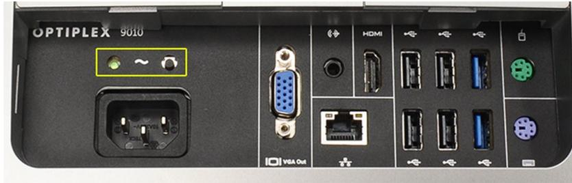
고객은 테스트 버튼을 눌러서 전원 시스템 상태를 테스트할 수 있습니다. 전원 공급 장치에서 **Power\_Good(PG)**이라고 하는 신호에 의해 이 버튼에 불이 들어옵니다. +3.3v, +5v 및 +12v 레일이 사양 내에서 정상 작동하면 **PG** 신호가 켜져 자체 검사 LED에 불이 들어옵니다. 유닛에서 이 검사를 통과하지 못하는 케이블 하니스를 제거하여 전원 공급 장치의 특정 연결 장치로 오류의 원인을 분리시킬 수 있습니다. 예를 들어, 버튼을 눌렀을 때 자체 검사 LED가 켜지지 않으면 장치에서 커넥터를 제거하고 다시 검사할 수 있습니다. 이제 **PG LED**가 켜지면 연결된 장치의 중 하나가 단락되어 전원 공급 장치의 작동을 방해하고 있었던 것입니다. LED가 켜지지 않으면 전원 공급 장치에 결함이 있는 것입니다.
