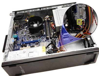
5. Svitare il cavo del sensore termico dai clip del telaio.
