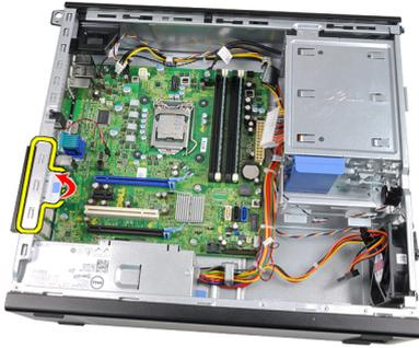
9. Rimuovere le viti che fissano la scheda di sistema al telaio.
