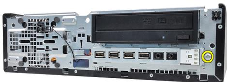
6. Far scorrere il pannello di Input/Output verso la destra del sistema per liberare il telaio.
