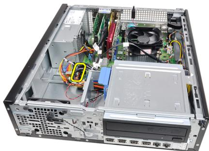
5. Rimuovere la vite che fissa il pannello di Input/Output al telaio.
