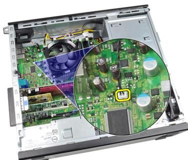
4. Svitare il cavo del sensore termico dalla clip del telaio.
