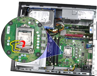
8. Sollevare il processore per rimuoverlo dallo zoccolo e collocarlo nell'involucro antistatico.
