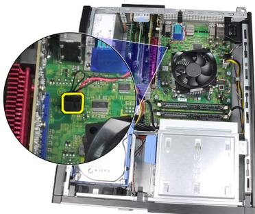
4. Far scorrere l'interruttore di apertura verso la parte inferiore della scheda di sistema e rimuoverlo.
