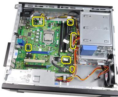
8. Sollevare e sbloccare il fermo della scheda di espansione per accedere alle viti che fissano la scheda di sistema.
