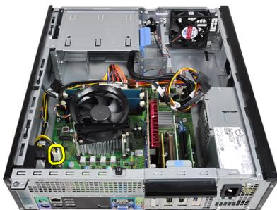
5. Svitare il cavo di alimentazione a 4 piedini dai clip del telaio.
