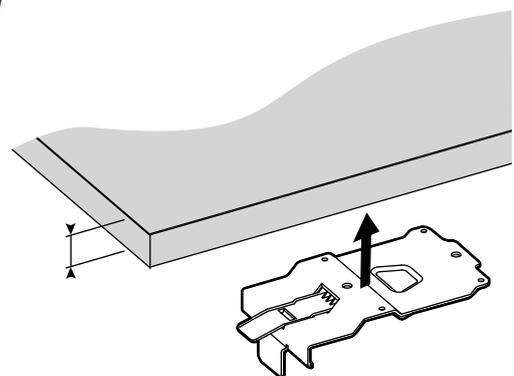
**Advertencia:** No se incluyen con soporte de sujetadores de montaje. Utilice sujetadores apropiados para conectar a una superficie de montaje sólida que puede soportar 50 libras (23 kg). Como mínimo, la superficie del montaje debe ser ½" (1,25 cm) madera gruesa y montar con 4 tornillos de madera de metales (M4 x 12 mm).
