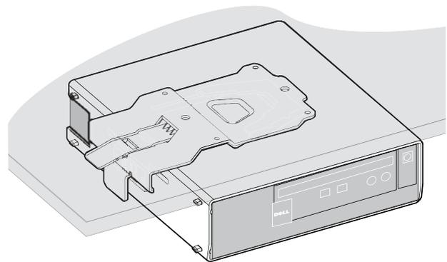
El soporte de montaje Dell OptiPlex 780-USFF sostiene el sistema en orientación vertical y horizontal.
