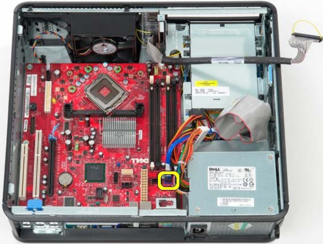
11. Staccare del cavo di alimentazione del processore.
