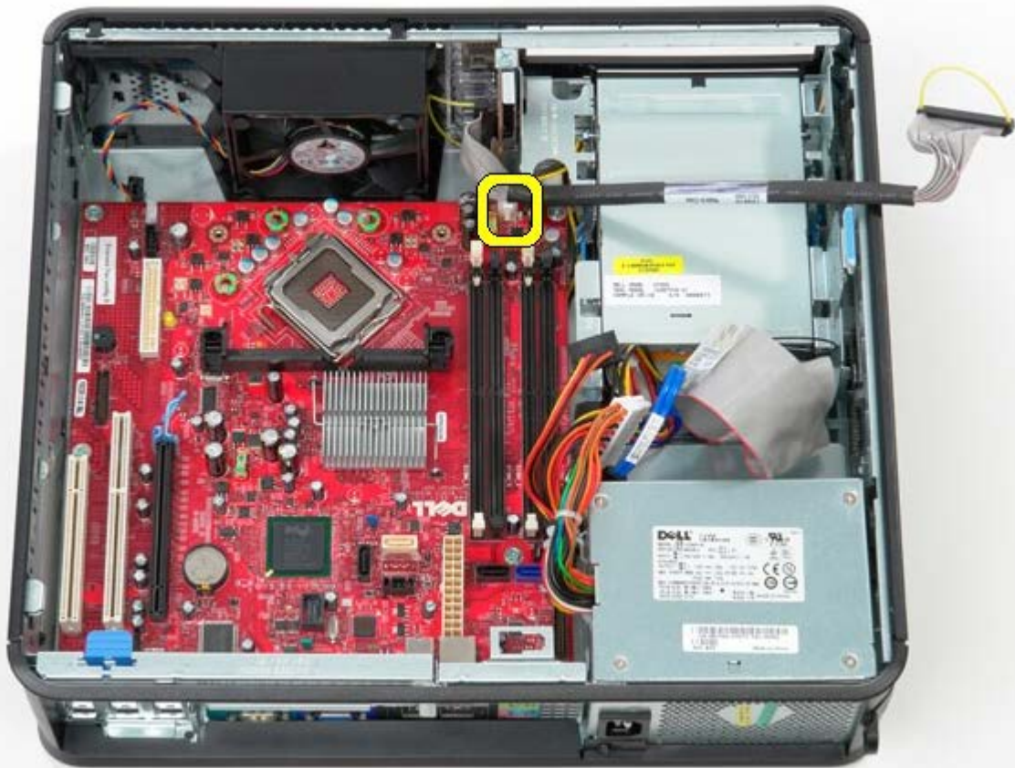
12. Rimuovere le viti che fissano la scheda di sistema al telaio del computer.
