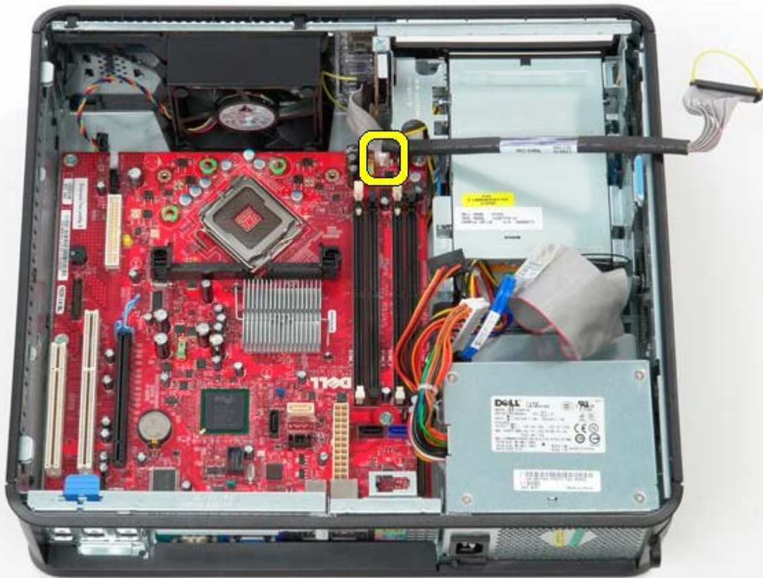
12. Irrota ruuvit, joilla emolevy on kiinnitetty tietokoneen koteloon.
