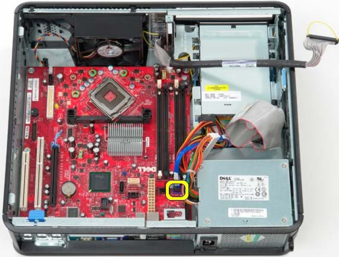
11. Irrota suorittimen virtakaapeli.
