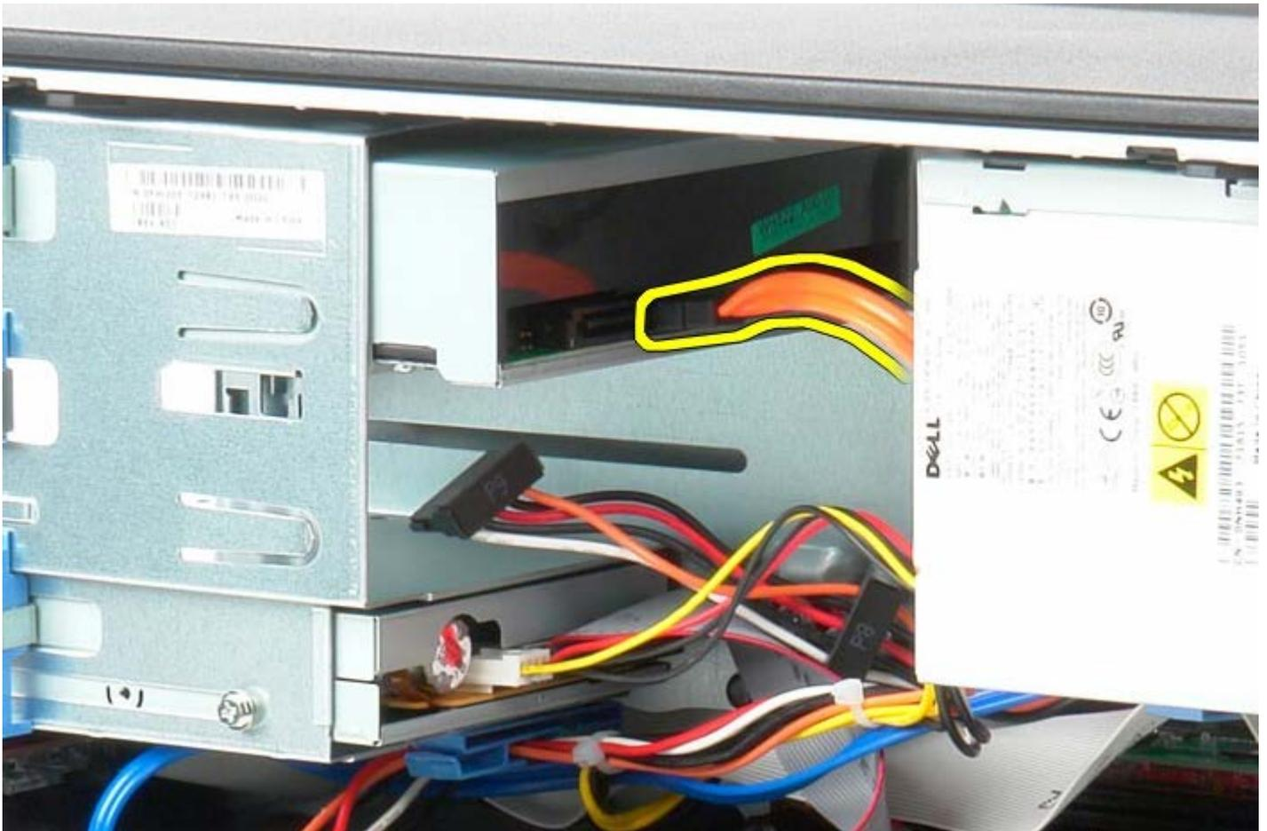
5. Faça deslizar o trinco de libertação da unidade em direcção à base do sistema e mantenha a pressão.
