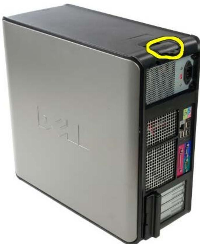
3. Incline a tampa do sistema para fora a partir da parte superior.
