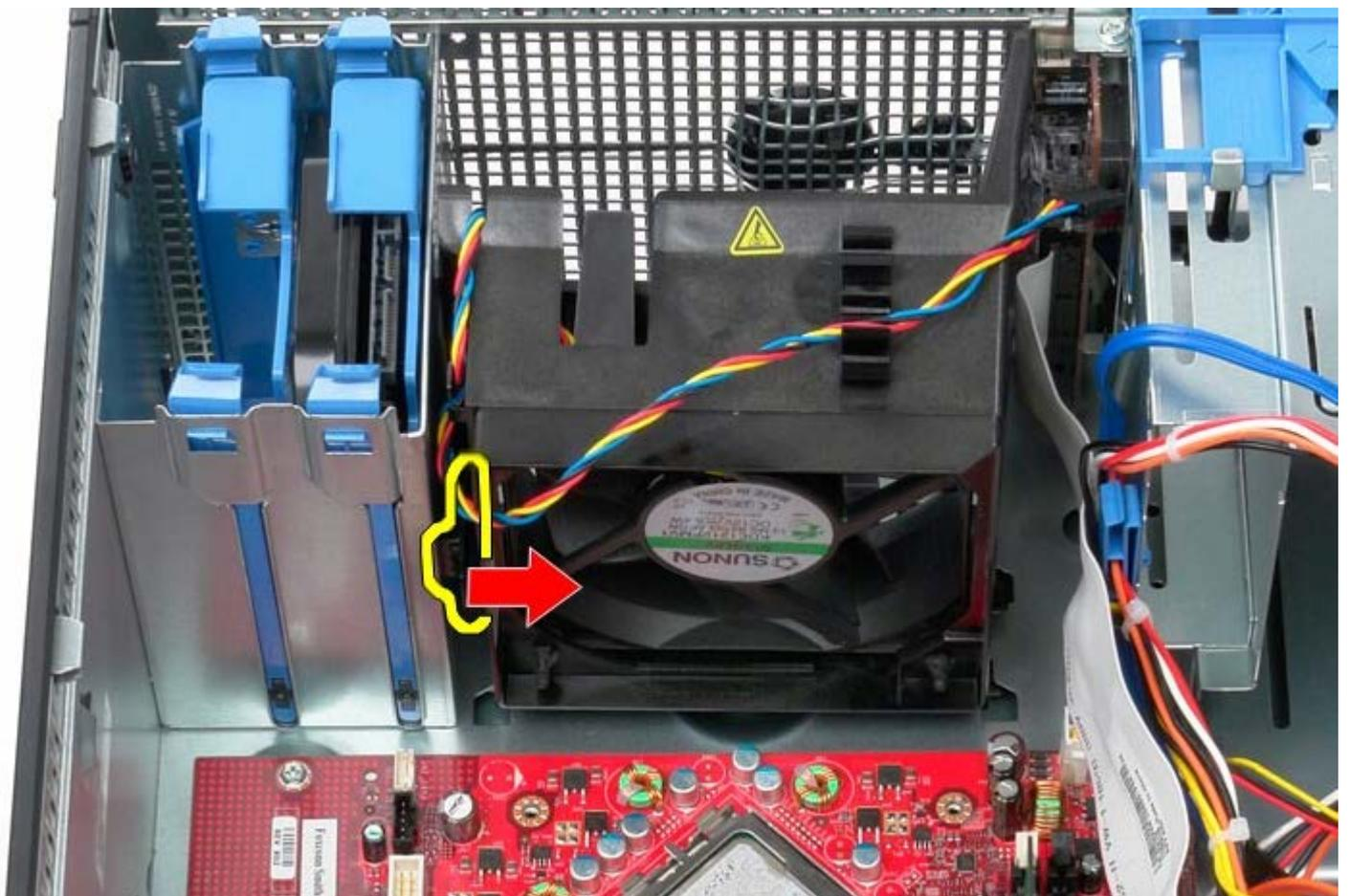
7. Faça deslizar a ventoinha do processador em direcção à parte posterior do computador.
