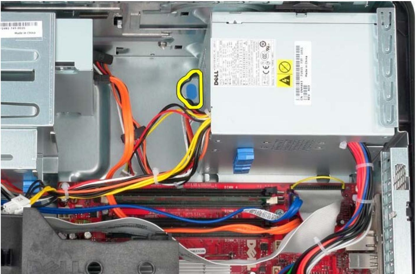
10. Faça deslizar a fonte de alimentação em direcção à parte anterior do computador e levante-a para cima e para fora do mesmo.
