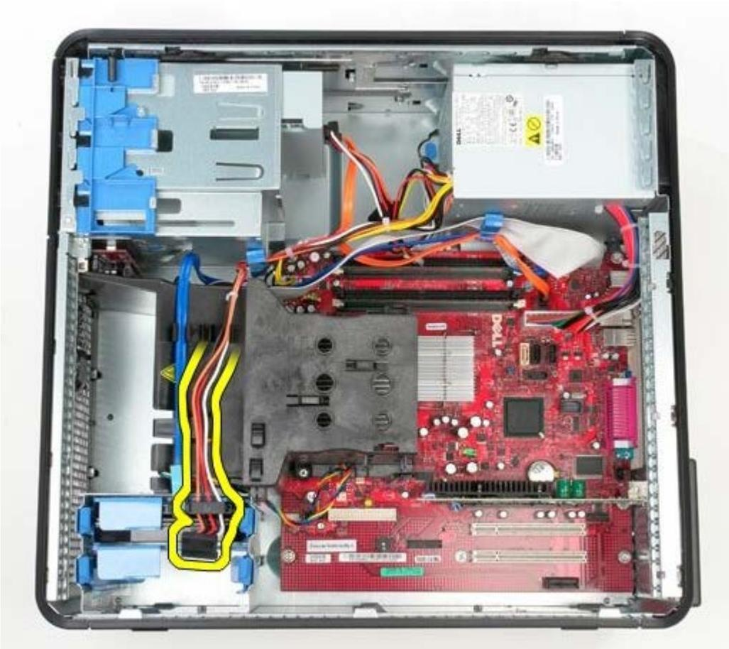
4. Desligue o cabo de alimentação da unidade óptica.
