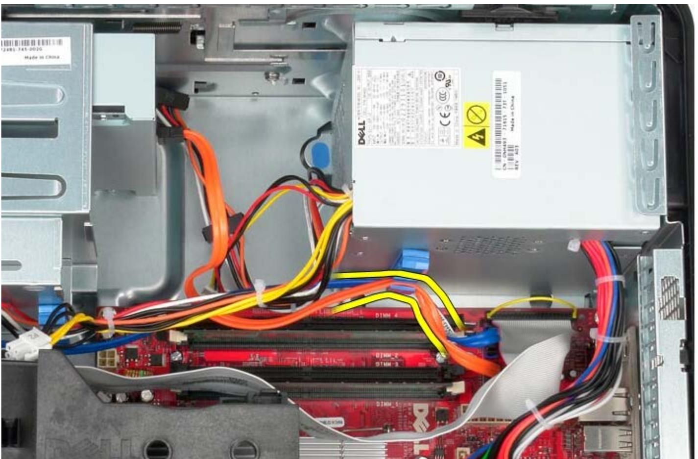
9. Prima o trinco de libertação que fixa a fonte de alimentação à estrutura.
