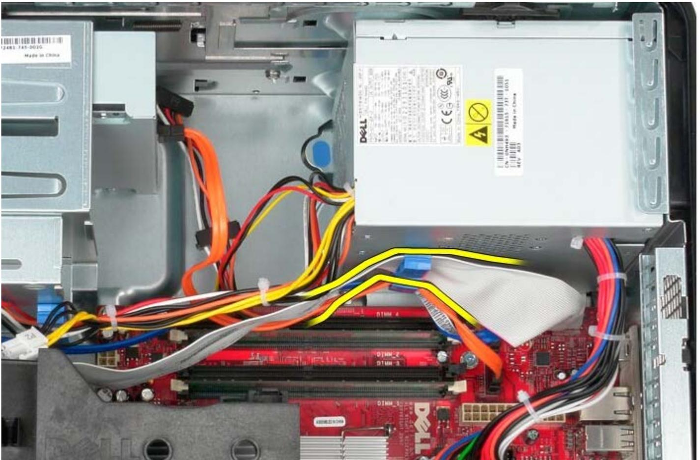
8. Retire quaisquer cabos de dados do encaminhamento de cabos na base da fonte de alimentação.
