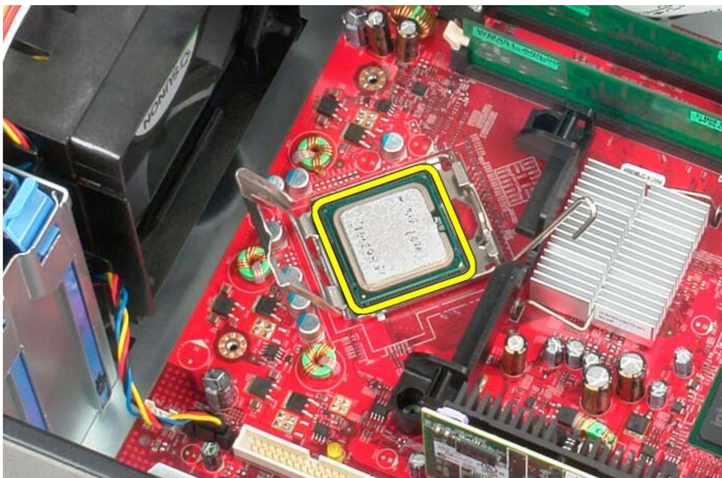
△ **AVISO:** Ao substituir o processador, não toque em nenhum dos pinos no interior do encaixe, nem deixe cair objectos sobre os pinos no encaixe.
