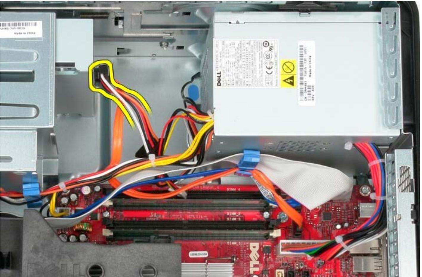
5. Desligue o cabo de alimentação do processador da placa de sistema.
