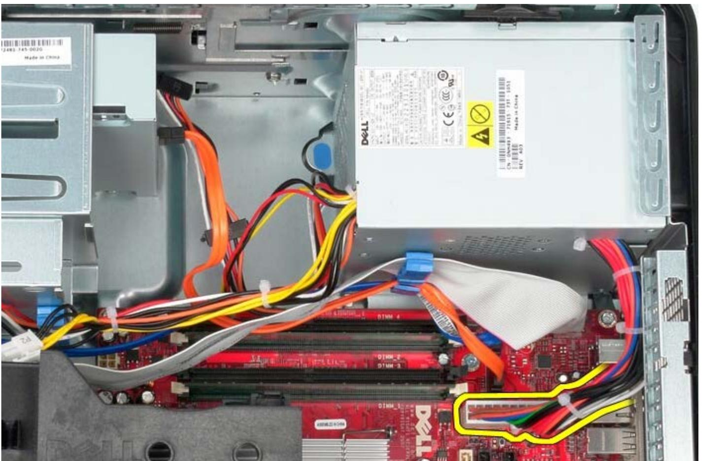
7. Retire o cabo de dados do painel de ES do encaminhamento de cabos na base da fonte de alimentação.
