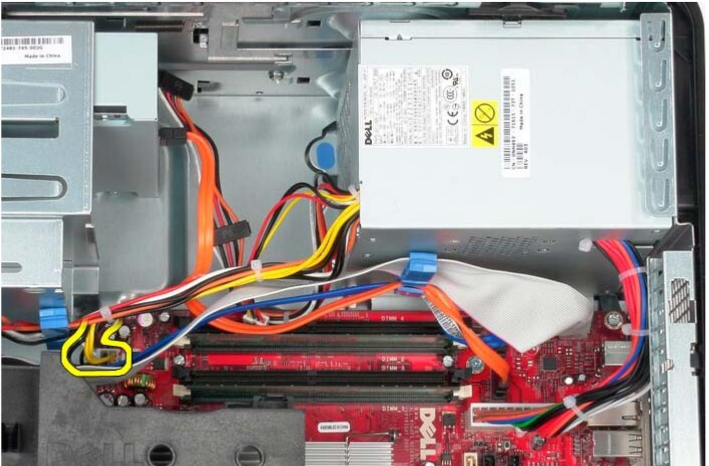
6. Desligue o cabo de alimentação principal da placa de sistema.
