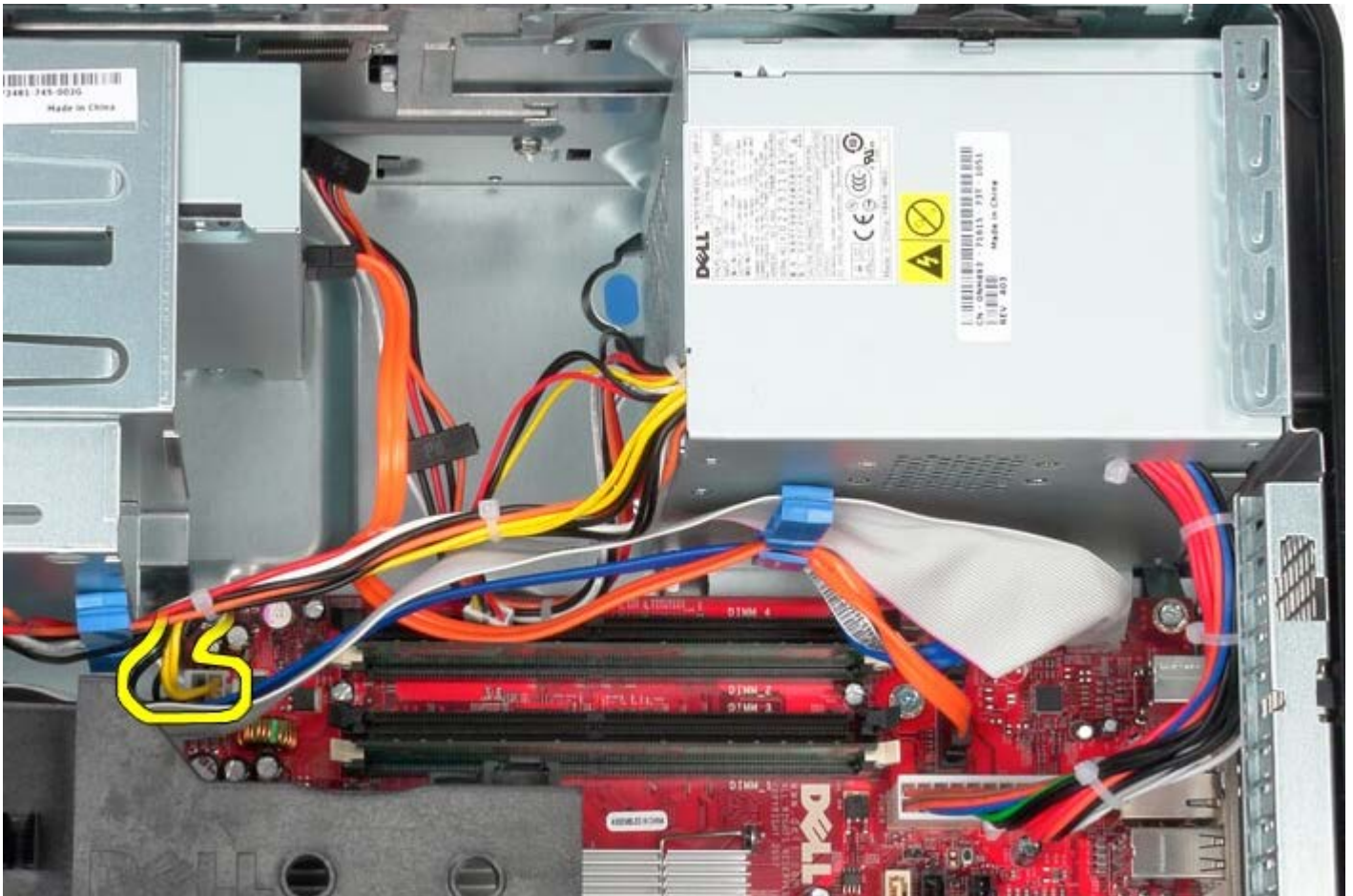
6. Frakobl hovedstrømkablet fra systemkortet.
