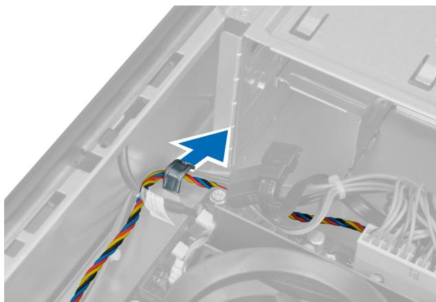
6. 將 24 插腳電源線從主機板壓下拔出。
