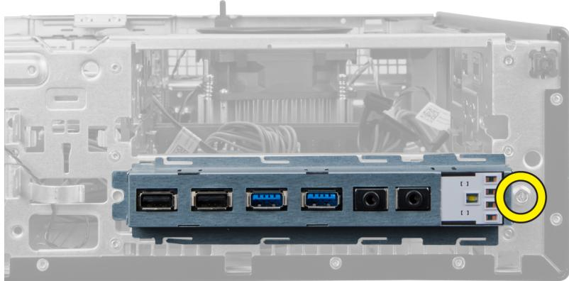
7. 將 I/O 面板向電腦左側推動，以將 I/O 面板鬆開並將它連同其纜線拉出電腦。
