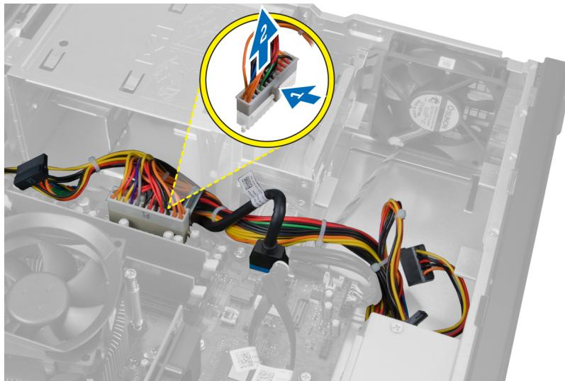
4. 將電源線和 I/O 纜線從機箱固定夾鬆開拉出。
