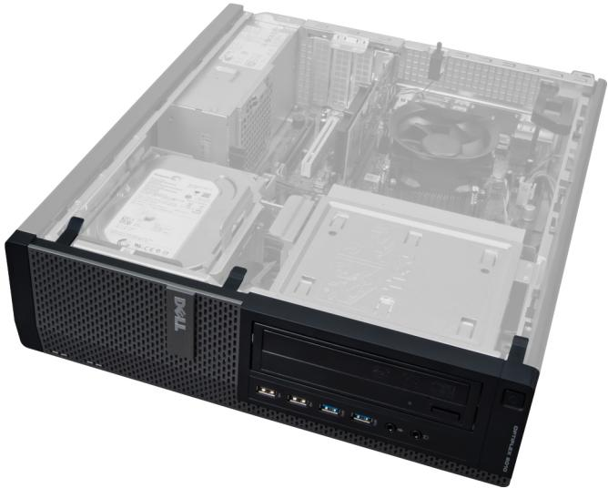
3. 從前蓋側緣的機箱輕輕撬開前面板固定夾。
