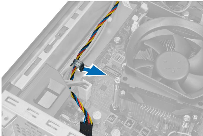
5. 將系統風扇纜線從機箱固定夾鬆開。
