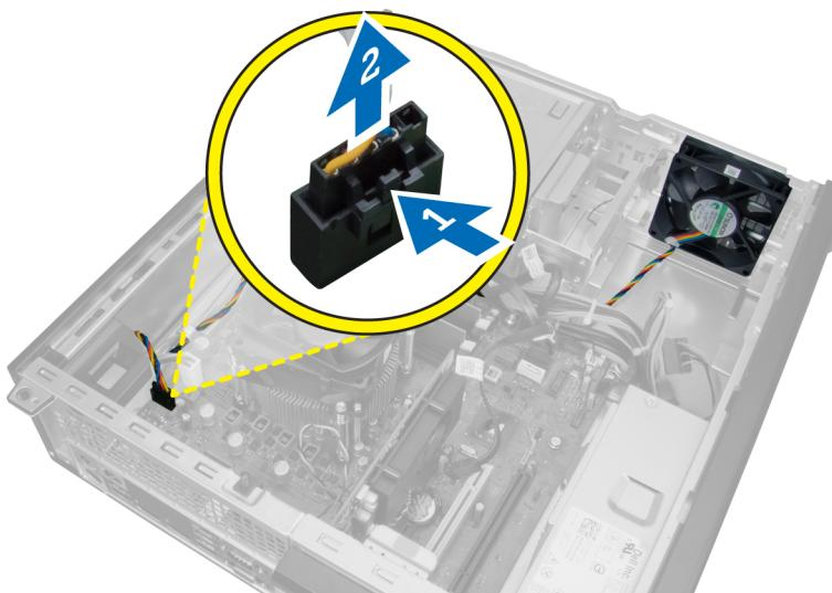
4. 將系統風扇纜線從機箱固定夾抽出。
