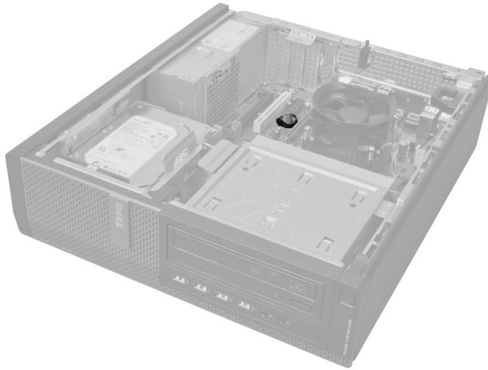
3. 輕輕向遠離電池的方向按壓電池釋放門鎖，使電池從電池槽中彈起，然後將幣式電池從電腦取出。
