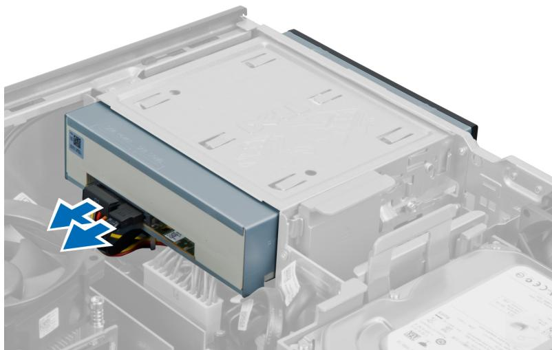
4. 向上抬起光碟機釋放門鎖，並將光碟機朝電腦前側推動。
