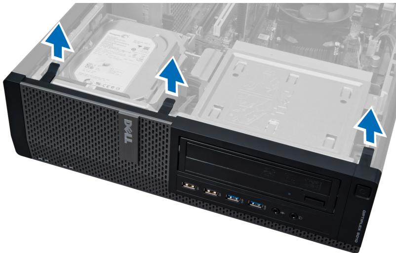
4. 向遠離機箱的方向旋轉前面板，以鬆開前面板另一側邊緣上的掛鉤。
