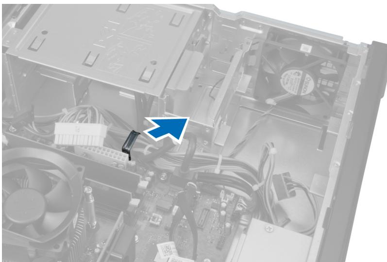
8. 撬開將系統風扇固定至電腦的 4 個扣眼，並將系統風扇卸下。
