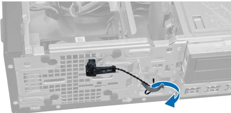
5. 輕壓兩側的彈片將熱感應器從機箱鬆開和卸下。
