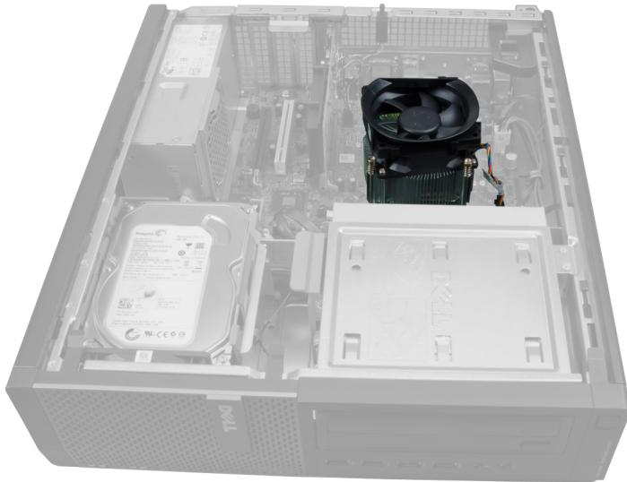
3. 壓下塑膠固定夾並從主機板拔下散熱器纜線。
