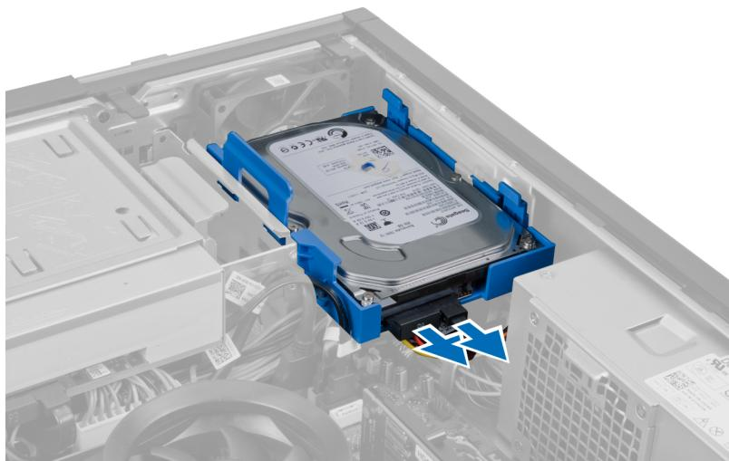
4. 將藍色固定托架向內壓，然後將硬碟機托架從支架傾斜抬起取出。
