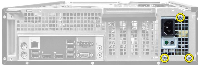
9. 推入電源供應器旁的藍色釋放彈片，然後將電源供應器朝向電腦前側推動。
