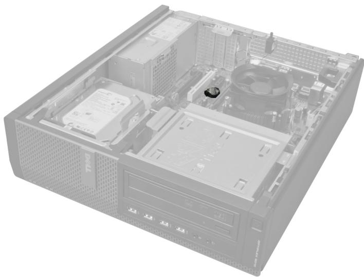
3. 輕輕向遠離電池的方向按壓電池釋放門鎖，使電池從電池槽中彈起，然後將幣式電池從電腦取出。
