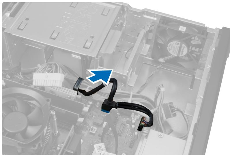
5. 壓下金屬固定夾然後向上拉，以拔下 USB 3.0 連接器。
