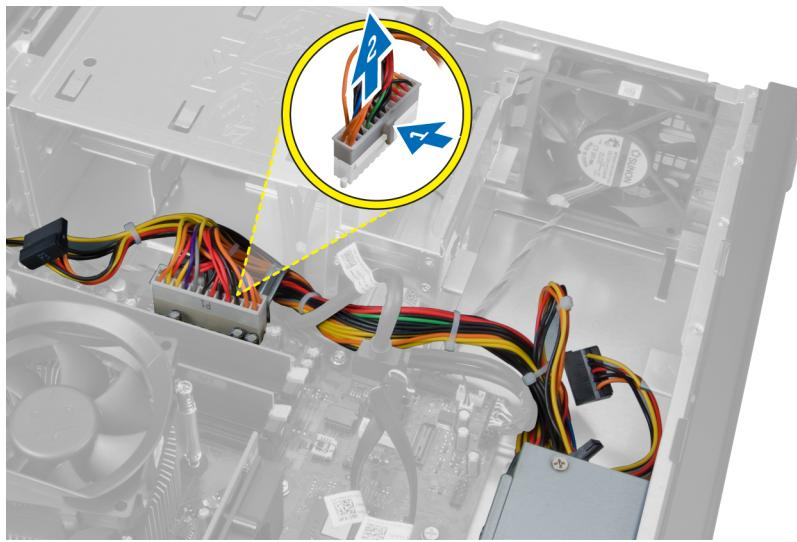
6. 將 24 插腳電源線從機箱固定夾抽出。
