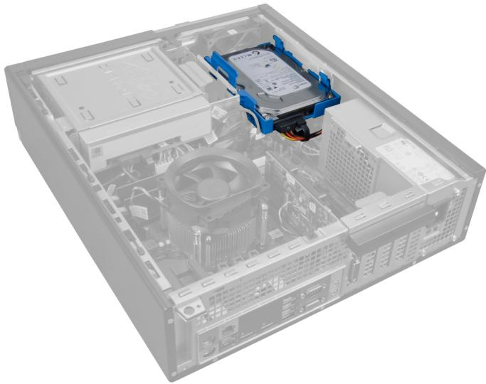
3. 將資料纜線和電源線從硬碟機背面卸下。
