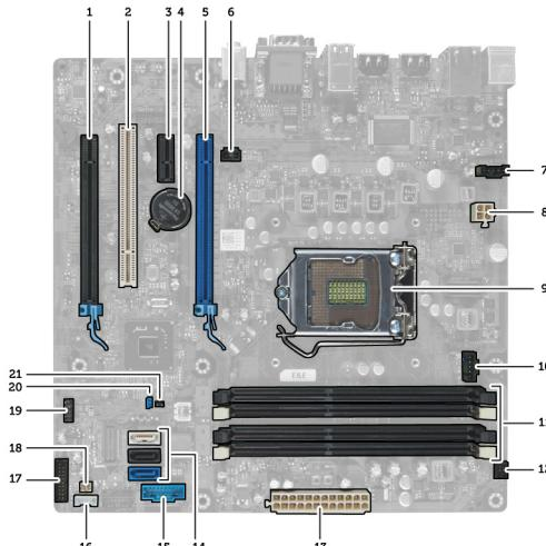
下圖顯示電腦的主機板配置。
