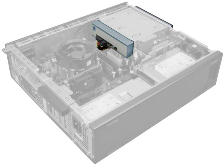
3. 將資料纜線和電源線從光碟機背面卸下。
