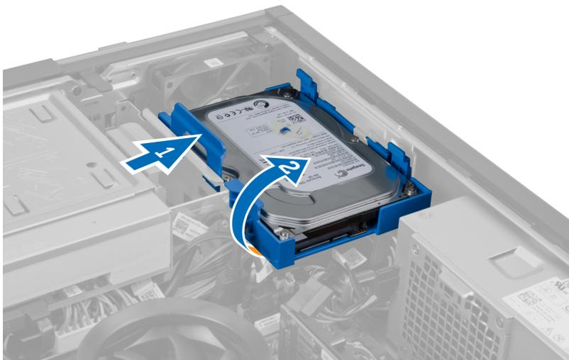
5. 鬆開硬碟機托架，然後將硬碟機從托架卸下。
