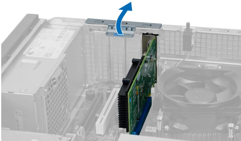
4. 從擴充卡推開釋放拉桿，然後將擴充卡從連接器輕輕拔出。
