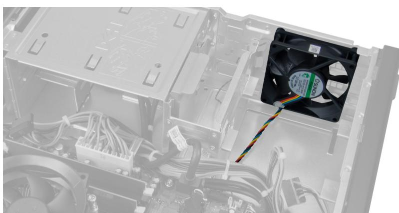
3. 壓下塑膠固定夾將系統風扇纜線從主機板鬆開。
