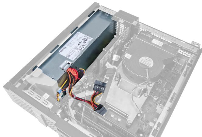
افصل كبل التيار ذو 4 سنتون من لوحة النظام وأخرج الكيل من مشابك اليكل.
