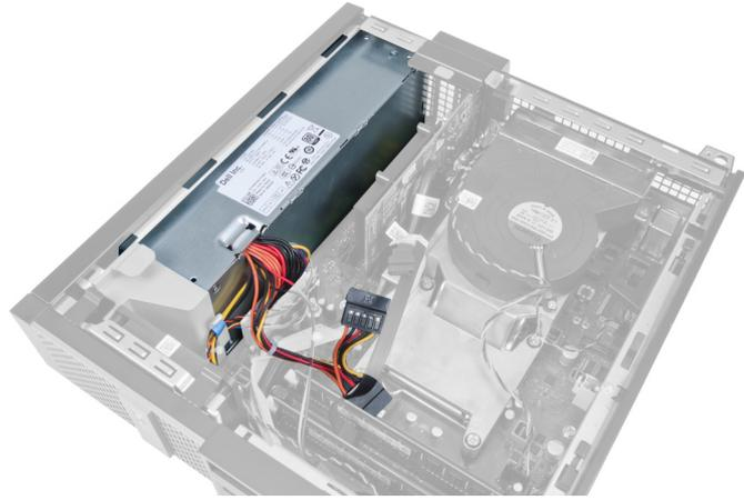
3. افصل كبل التيار ذو 4 سنون من لوحة النظام وأخرج الكبل من مشابك الهيكل.
