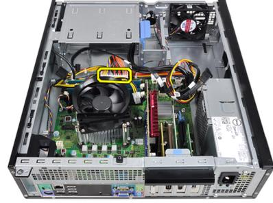
7. أخرج كبل التيار ذو الـ 24 سنا من مشابك الهيكل.
