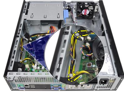
6. افضل كبل التيار ذو الـ 24 سنا من لوحة النظام.
