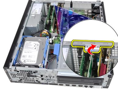
4. اسحب ذراع التحرير بعيدًا عن بطاقة PCIe x16 حتى تقوم بتحرير عروة التثبيت من السن الموجود في البطاقة. ثم، قم بتحرير البطاقة لاعلى وخارج الموصل الخاص به، ثم قم بإزالتها من الكمبيوتر.
