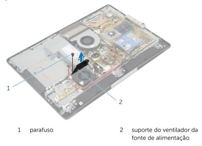
**3** Desconecte o cabo do ventilador da fonte de alimentação da unidade de fonte de alimentação.
