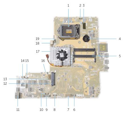
1 soquete do processador 2 conector do cabo da câmera
