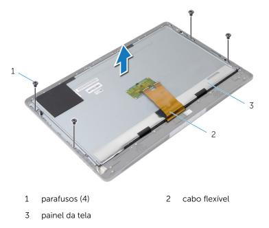
Remova os parafusos que prendem os suportes do painel da tela no painel da tela.
