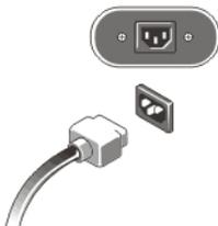
**Figure 10. Connexion de l'alimentation**
