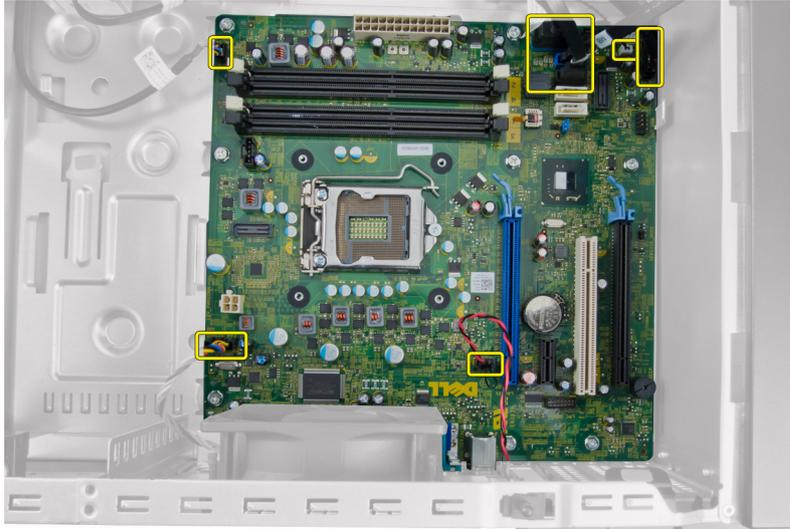
4. 拧下将系统板固定至计算机的螺钉。
