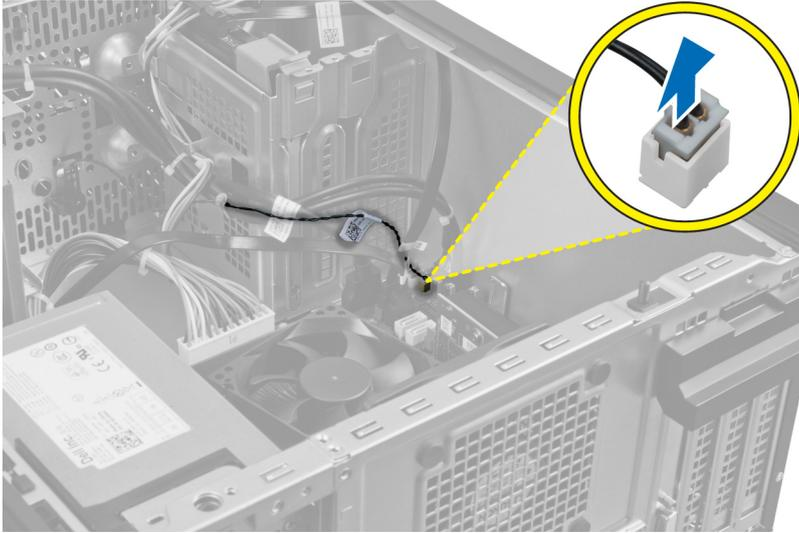
4. 将热感器电缆从机箱固定夹中释放。
