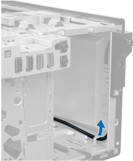
5. 按下电源开关两侧的固定夹，以从机箱中释放电源开关，然后将电源开关拉出计算机。将电源开关连同其电缆从计算机的前面滑出。
