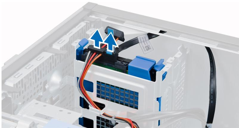
4. 向内按固定卡舌，并将硬盘驱动器支架从驱动器托架中提出。
