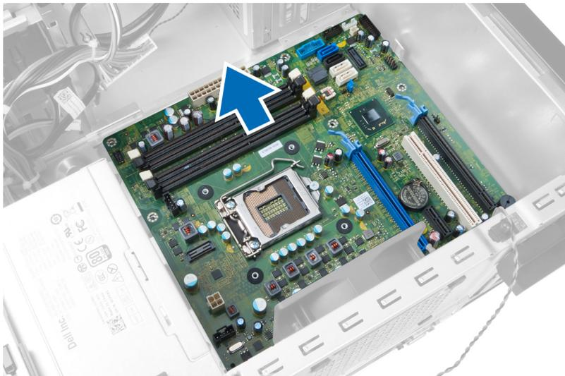
6. 将系统板倾斜 45 度，然后将系统板从计算机中提出。
