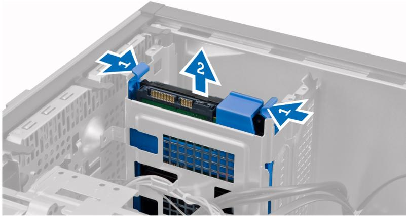
5. 弯曲硬盘驱动器支架，然后将硬盘驱动器从支架中卸下。
