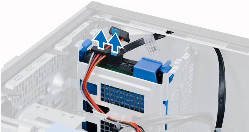
4. Presione las dos lengüetas de fijación hacia dentro y extraiga el soporte para unidades de disco duro del compartimento para unidades.
