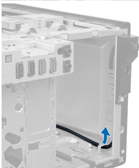
5. Presione los enganches de los dos lados del interruptor de alimentación para liberarlo del chasis y extraer el interruptor de alimentación del equipo. Deslice el interruptor de alimentación con su cable y extráigalo por la parte anterior del equipo.
