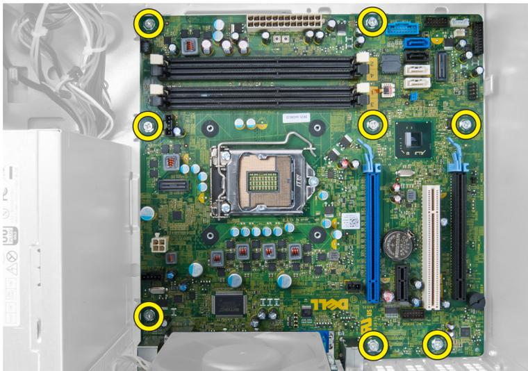
5. Deslice la placa base hacia la parte frontal del equipo.
