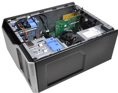
4. 向远离计算机方向旋转前挡板，从机箱上释放前挡板另一侧上的挂钩。
