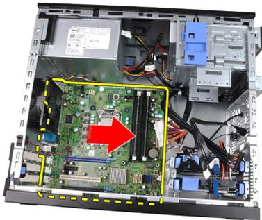
9. 将系统板小心倾斜 45 度，然后将系统板从计算机中提出。
