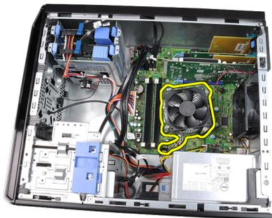
6. 向下按压释放拉杆，然后向外移动，从固定拉杆的固定挂钩上释放拉杆。
