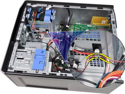
5. 向下按压扬声器固定卡舌，并将扬声器向上滑动使其卸下。
