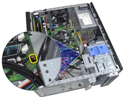
6. 将电源开关电缆从机箱固定夹中抽出。
