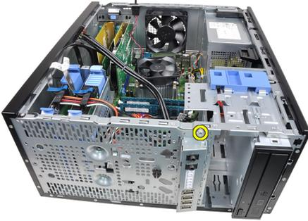
7. 将 I/O 面板向计算机左侧滑动以释放该面板。
