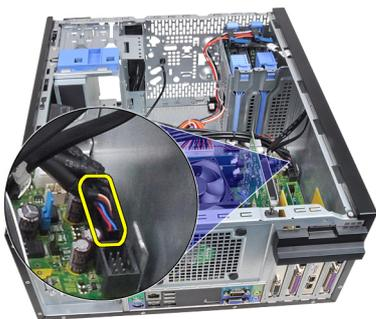
5. 将 I/O 面板和 FlyWire 电缆从计算机固定夹中抽出。
