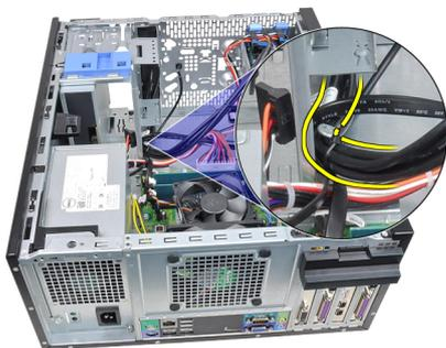
6. 拧下将 I/O 面板固定到计算机上的螺钉。
