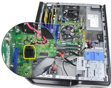
4. 将防盗开关滑入机箱底部，然后从机箱中卸下。
