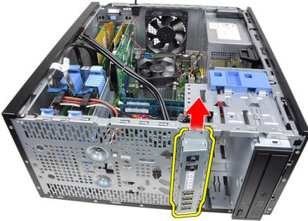
8. 通过将电缆布放到计算机前侧，卸下 I/O 面板。
