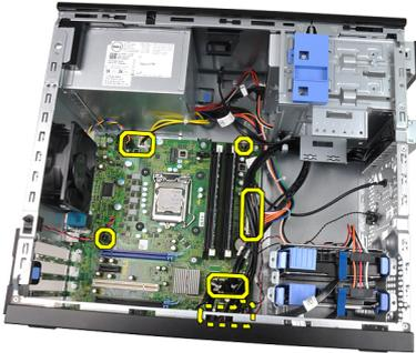
7. 拧下将系统板固定到计算机的螺钉。
