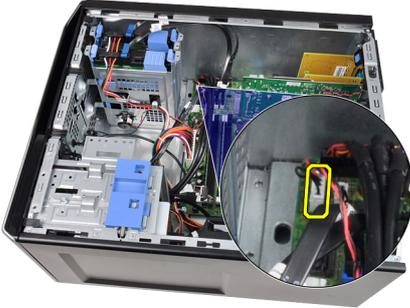
4. 将内置扬声器电缆从机箱固定夹中抽出。
