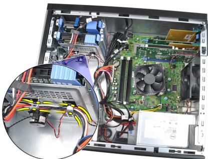
5. 断开 24 针电源电缆与系统板的连接。
