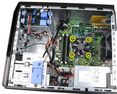
5. 将散热器/风扇组件轻轻向上提起，并将其从系统卸下。将组件以风扇朝下、散热器朝上的方向放置。
