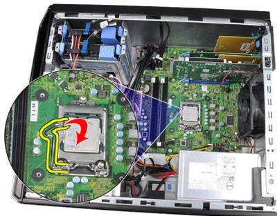
8. 将处理器从插槽中提起拔出，并将其置于防静电包装中。
