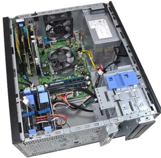
9. 将电源开关电缆从计算机正面滑出。
