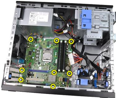
8. 将系统板向计算机正面滑动。
