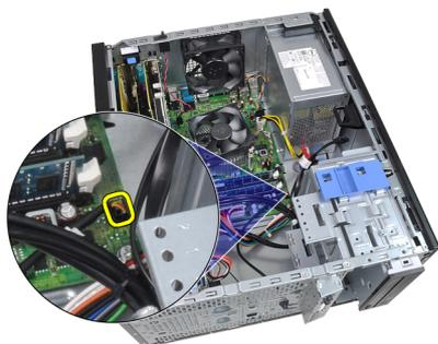
6. Retirez le câble de l'interrupteur d'alimentation des clips du châssis.
