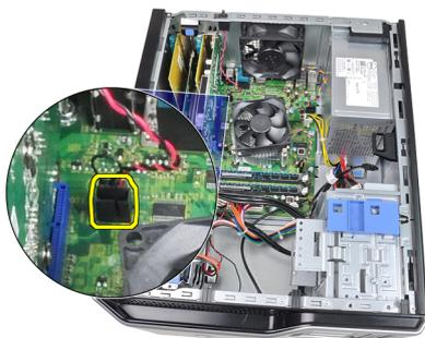
4. Amenez le commutateur d'intrusion vers l'arrière du châssis et retirez-le du châssis.
