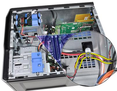
5. Retirez le capteur de l'avant du châssis et sortez-le.
