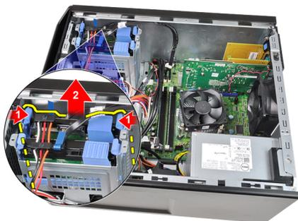
5. Courbez le support du disque dur et retirez le disque dur du support.
