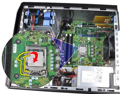
8. Soulevez le processeur pour le retirez du connecteur et placez-le dans un sac antistatique.
