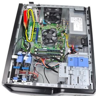
7. Levante la tarjeta de expansión PCI x4 (si la hay) para sacarla de su conector y extraerla del equipo.
