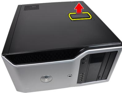
3. Levante la cubierta hacia arriba con un ángulo de 45 grados y retírela del equipo.
