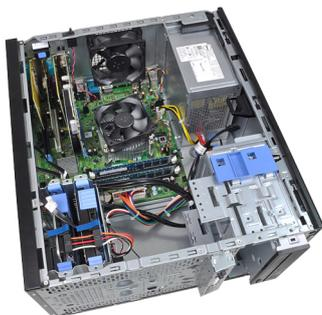
9. Saque el cable del interruptor de alimentación a través de la parte frontal del equipo.
