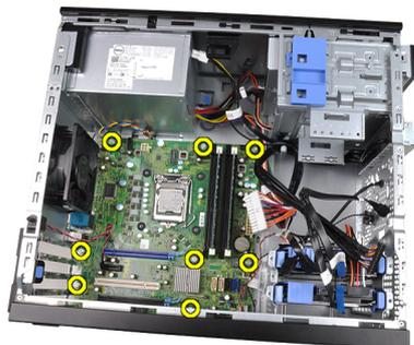
8. Deslice la placa base hacia la parte frontal del equipo.
