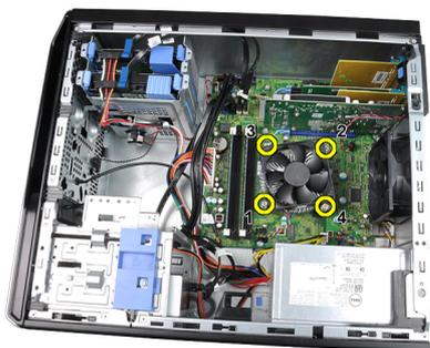
5. Levante con cuidado el ensamblaje del disipador de calor y el ventilador y sáquelo del sistema. Apóyelo con el ventilador mirando hacia abajo y con la grasa térmica hacia arriba.
