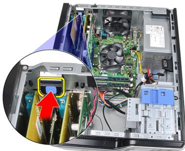
4. Tire con cuidado de la palanca de liberación de la tarjeta PCIe x16 hasta que se suelte la pestaña de fijación de la hendidura de la tarjeta. Después deslice la tarjeta para sacarla de su conector y extraerla del equipo.
