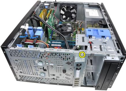
7. Deslice el panel de entrada/salida hacia la izquierda del equipo para soltarlo.
