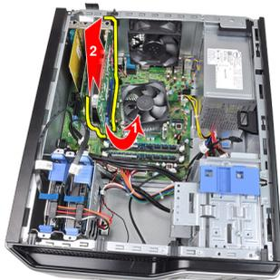
5. Deslice la tarjeta de expansión PCIe x1 (si la hay) para sacarla de su conector y extraerla del equipo.
