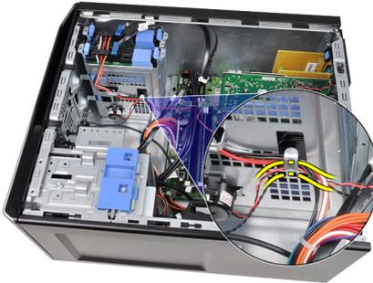
5. Presione la pestaña de seguridad del altavoz y deslice éste hacia arriba para extraerlo.
