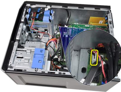
4. Desenrosque el cable del altavoz interno del gancho del chasis.
