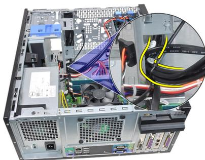
6. Extraiga el tornillo que fija el panel de entrada/salida al equipo.
