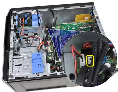
4. Desenrosque el cable del sensor térmico del gancho del chasis.
