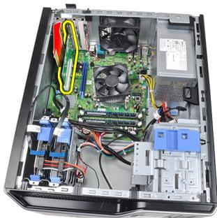
6. Levante la tarjeta de expansión PCIe (si la hay) para sacarla de su conector y extraerla del equipo.
