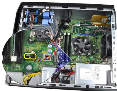
4. Utilice un destornillador Phillips para aflojar los tornillos cautivos que fijan el ensamblaje del disipador de calor y el ventilador a la placa base.
