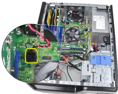
4. Deslice el interruptor de intrusiones hacia la parte inferior del chasis y extráigalo.
