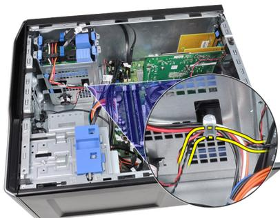
5. Saque con cuidado el sensor térmico de la parte frontal del chasis.
