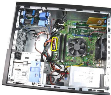
6. Desconecte el cable de alimentación de 4 patas de la placa base.
