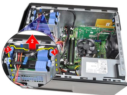
5. Biegen Sie die Festplattenlaufwerkhalterung und nehmen Sie das Festplattenlaufwerk heraus.
