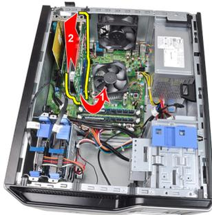
5. Heben Sie die PCIe x1-Erweiterungskarte (falls vorhanden) hoch und aus Ihrem Anschluss und entfernen Sie sie aus dem System.
