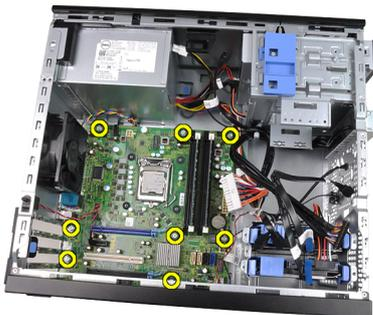
8. Schieben Sie die Systemplatine zur Vorderseite des Computers.
