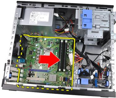
9. Winkeln Sie die Systemplatine vorsichtig um 45 Grad an und heben Sie sie dann aus dem Computer.
