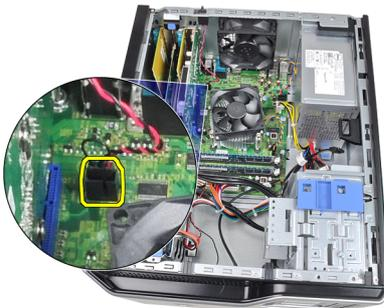
4. Schieben Sie den Eingriffsschalter im Gehäuse nach unten und entfernen Sie ihn aus dem Gehäuse.
