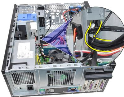
6. Entfernen Sie die Schraube, mit der die E/A-Leiste am Computer befestigt ist.
