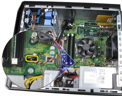
4. Lösen Sie mit einem Kreuzschlitzschraubenzieher die unverlierbaren Schrauben, mit denen die Kühlkörper-Lüfterbaugruppe an der Systemplatine befestigt wird.
