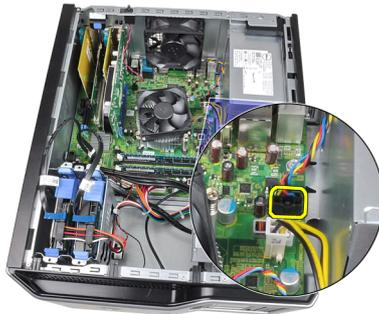
4. Hebeln Sie den Systemlüfter von den vier Gummiösen weg, mit denen er auf der Rückseite des Computers befestigt ist und entfernen Sie ihn.
