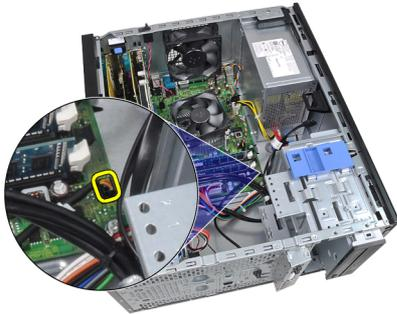
6. Lösen Sie das Betriebsschalterkabel aus den Gehäuseklammern.
