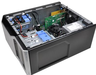
4. Drehen Sie die Verkleidung seitlich vom Computer weg, um die Haken auf der gegenüberliegenden Seite der Verkleidung aus dem Gehäuse zu entfernen.
