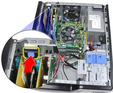
4. Drücken Sie den Entriegelungshebel vorsichtig von der PCIe x16-Karte weg, bis Sie die Sicherungslasche von der Einbuchtung in der Karte lösen. Dann ziehen Sie die Karte vorsichtig nach oben und aus ihrem Anschluss und entfernen sie aus dem System.
