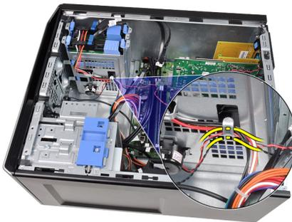
5. Drücken Sie die Sicherungslasche des Lautsprechers herunter und schieben Sie den Lautsprecher nach oben, um ihn zu sichern.
