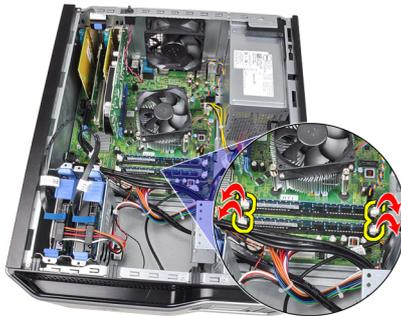
4. Heben Sie die Speichermodule aus den Anschlüssen auf der Systemplatine.
