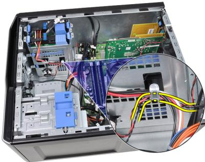
5. Hebeln Sie den Temperatursensor vorsichtig von der Gehäusevorderseite weg und entfernen Sie ihn.
