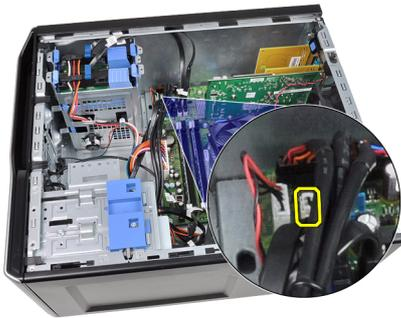
4. Lösen Sie das Kabel des Temperatursensors aus der Gehäuseklammer.
