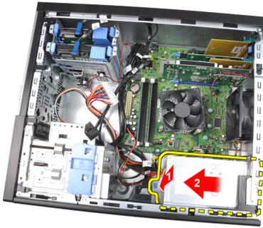
9. Heben Sie das Netzteil aus dem Computer heraus.
