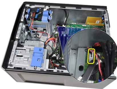
4. Lösen Sie das Kabel des internen Lautsprechers aus der Klammer am Gehäuse.
