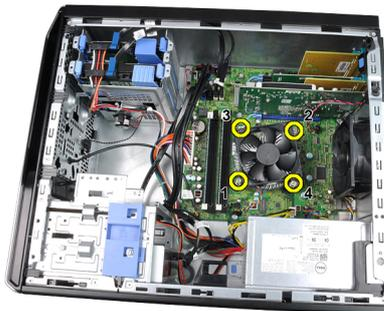
5. Heben Sie die Kühlkörper- Lüfterbaugruppe vorsichtig an und entfernen Sie sie vom System. Legen Sie die Baugruppe mit nach unten gerichtetem Lüfter und nach oben weisender Wärmeleitpaste hin.
