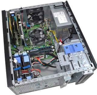
**9.** Schieben Sie das Betriebsschalterkabel durch die Vorderseite aus dem Computer heraus.
