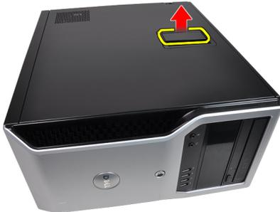
3. Heben Sie die Abdeckung in einem Winkel von 45 Grad an und entfernen Sie sie vom Computer.
