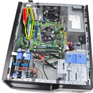
7. Heben Sie die PCIe x4-Erweiterungskarte (falls vorhanden) hoch und aus Ihrem Anschluss und entfernen Sie sie aus dem System.
