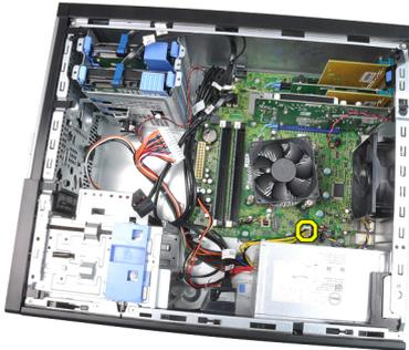
7. Entfernen Sie die vier Schrauben, mit denen das Netzteil an der Rückseite des Computers befestigt ist.
