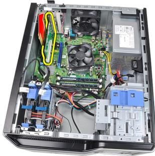
6. Heben Sie die PCI-Erweiterungskarte (falls vorhanden) hoch und aus Ihrem Anschluss und entfernen Sie sie aus dem System.
