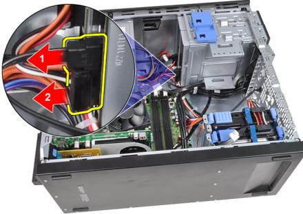
5. Schieben Sie den Riegel des optischen Laufwerks herunter und drücken Sie das optische Laufwerk von der Rückseite in Richtung Vorderseite des Computers.
