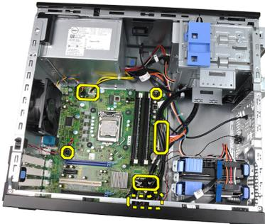
7. Entfernen Sie die Schrauben, mit denen die Systemplatine am Computer befestigt ist.
