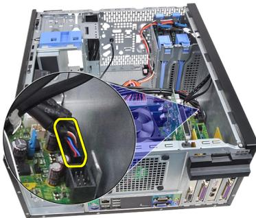
5. Lösen Sie die E/A-Leiste und das FlyWire-Kabel von der Klammer am Computer.
