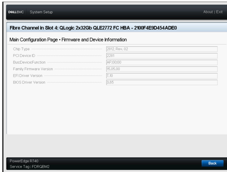
Ilustración 3-14. Dell System Setup: Firmware and Device Information (Configuración del sistema Dell: Información de firmware y dispositivo)
