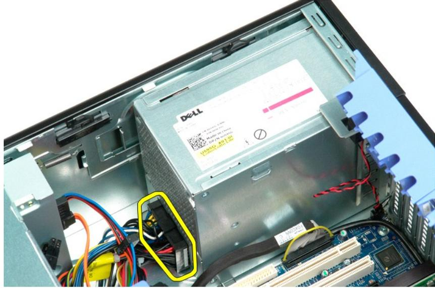
6. اضغط لأسفل مع الاستمرار على مثبتك تحرير وحدة التزويد بالطاقة (1)، ثم قم بتحريك وحدة التزويد بالطاقة باتجاه مركز الكمبيوتر (2).
