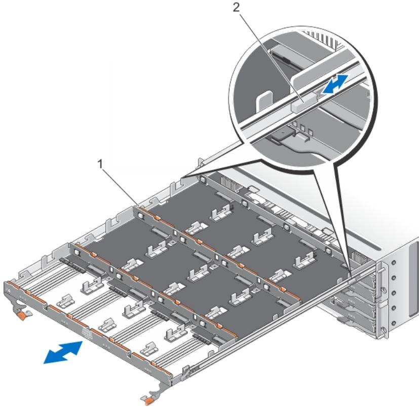
그림 18. 실제 디스크 드라이브 분리 및 설치
