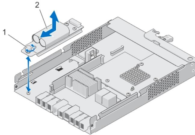
그림 28. RAID 컨트롤러 모듈 백업 배터리 장치 분리 및 설치
