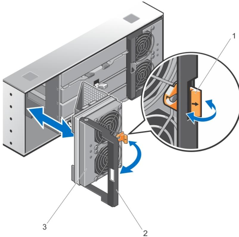
그림 30. 냉각 팬 모듈 분리 및 설치
