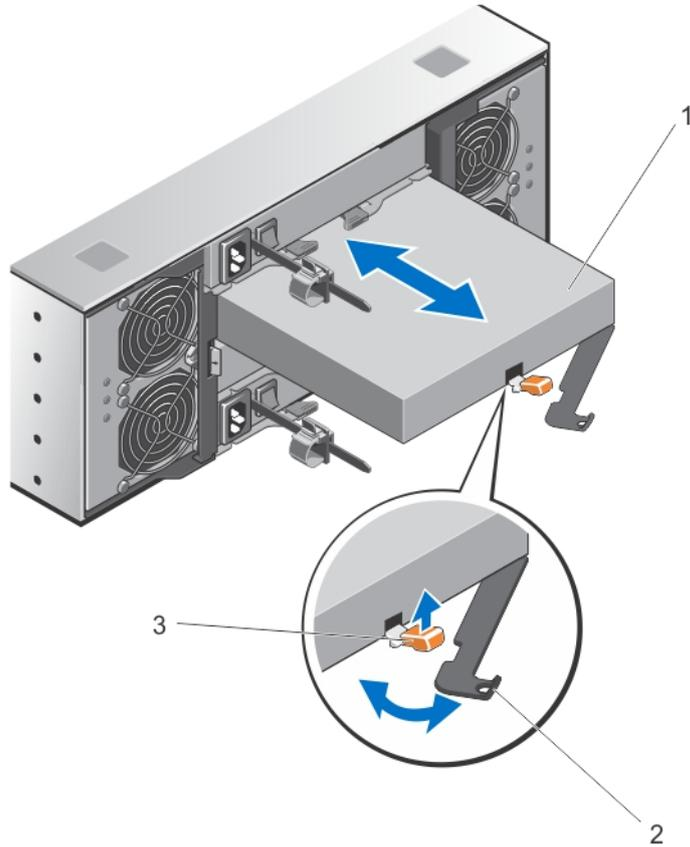
그림 25. RAID 컨트롤러 모듈 또는 확장 모듈의 분리 및 설치
