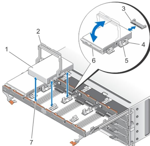
그림 22. 실제 디스크 드라이브에서 실제 디스크 분리 및 설치
