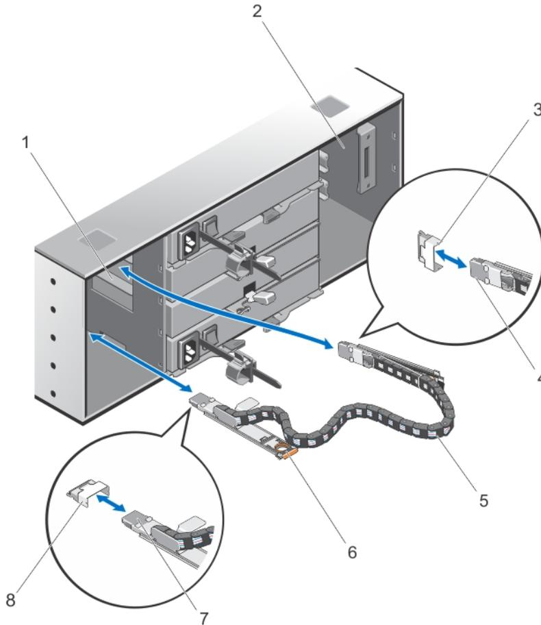
그림 24. SAS 체인 케이블 분리 및 설치
