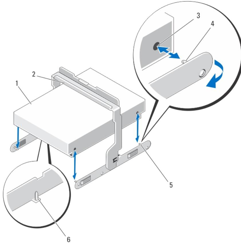
그림 21. 3.5 인치 실제 디스크 캐리어에서 3.5 인치 실제 디스크 분리 및 설치
