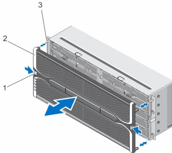
그림 15. 전면 베젤 분리 및 설치
