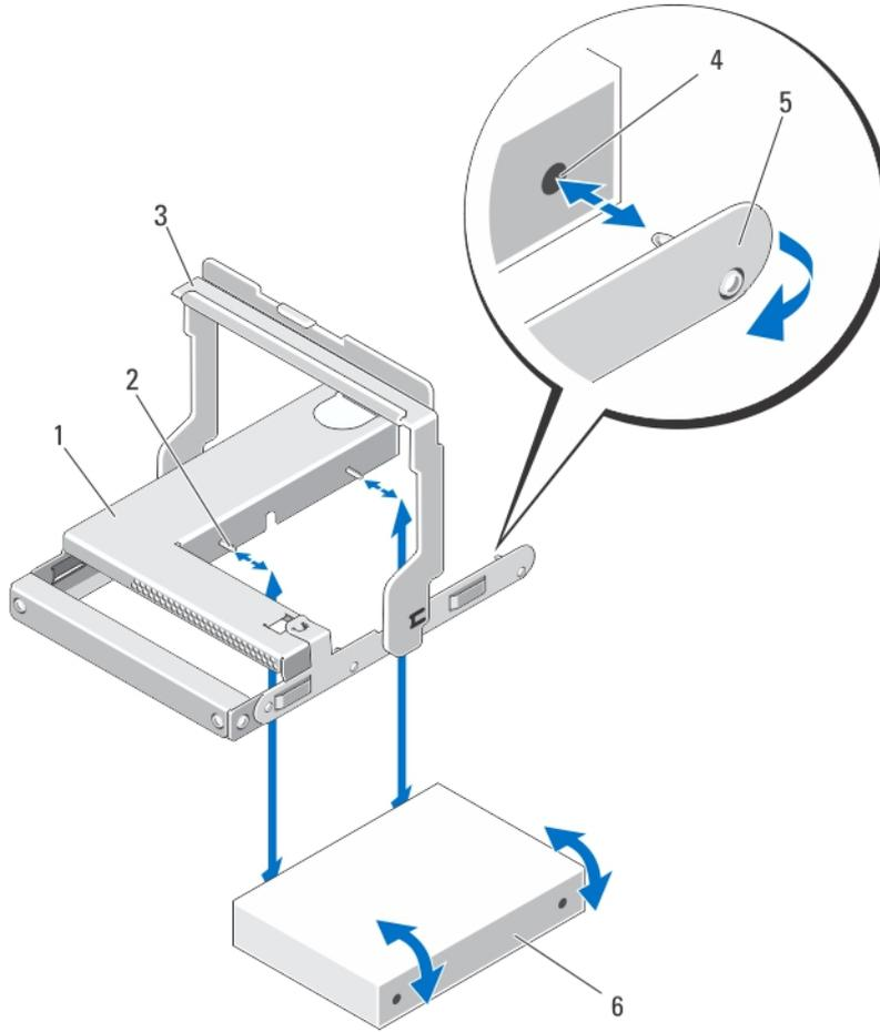
그림 20. 2.5 인치 실제 디스크 캐리어에서 2.5 인치 실제 디스크 분리 및 설치
