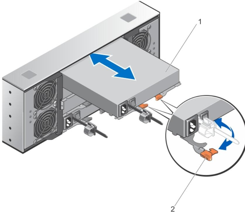
그림 29. 전원 공급 장치 모듈 분리 및 설치
