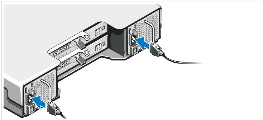
電源ケーブルを接続する前に、電源スイッチがオフになっていることを確認してください。システムに電源コードを接続します。
