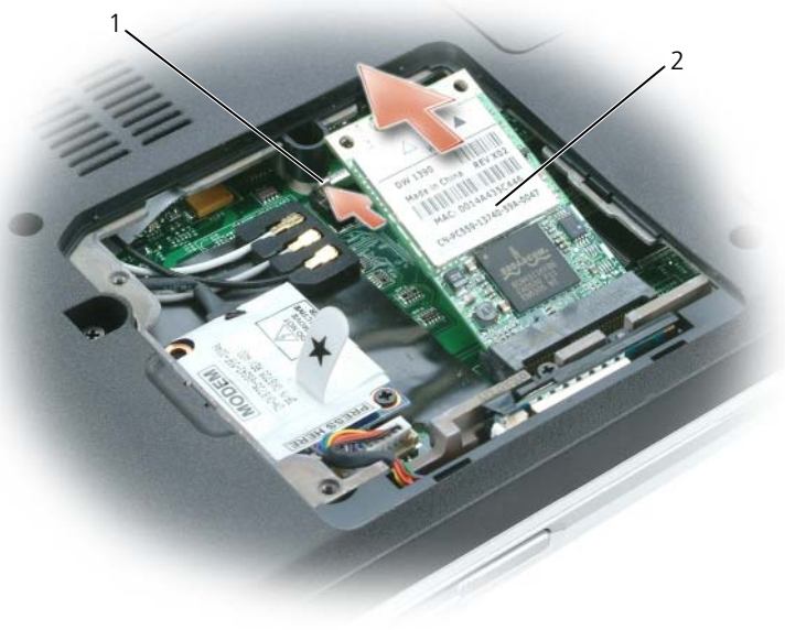
1 金属製固定タブ (2) 2 ミニカード
