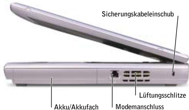
**AKKU/AKKUSCHACHT** — Wenn ein Akku installiert ist, kann der Computer verwendet werden, ohne dass er an eine Steckdose angeschlossen wird. Siehe Seite 41.
