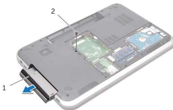
1 Ensamblaje de la unidad óptica
