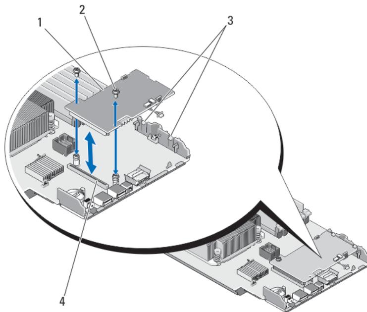
图 22: 卸下和安装存储控制器卡
