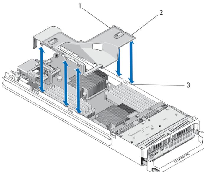
图 8: 卸下和安装冷却导流罩
