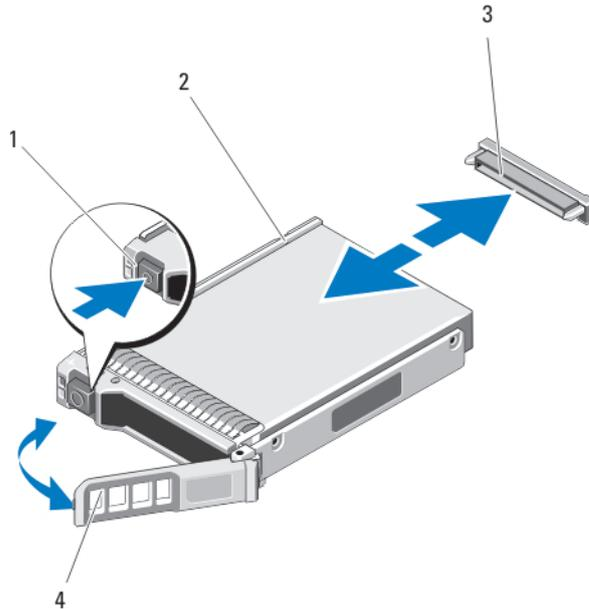
图 17: 卸下和安装硬盘驱动器/SSD
