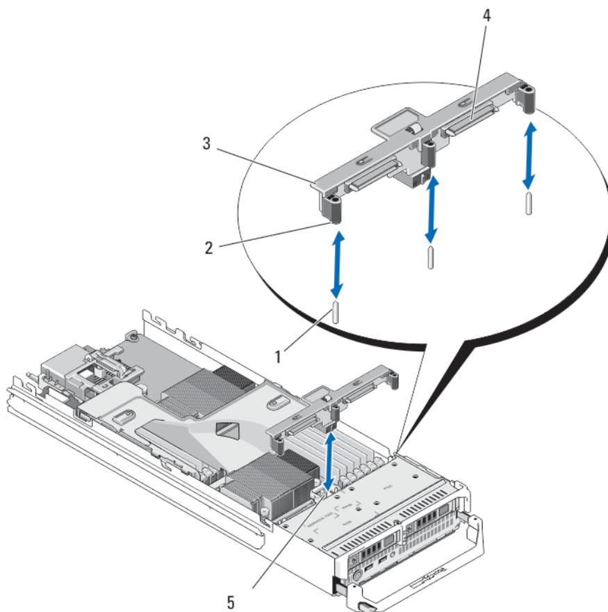
图 19: 卸下和安装硬盘驱动器/SSD 背板
