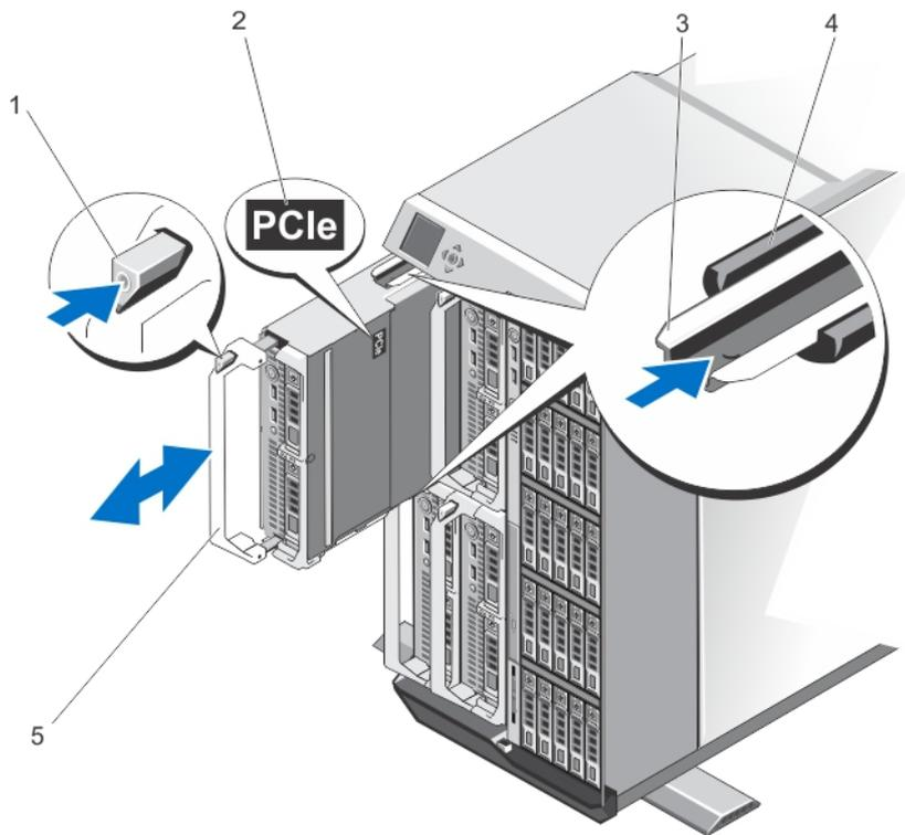
图 5: 卸下和安装服务器模块
