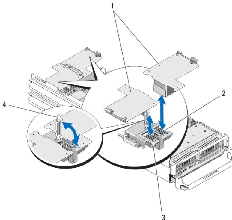
图 11: 卸下和安装 PCIe 夹层卡
