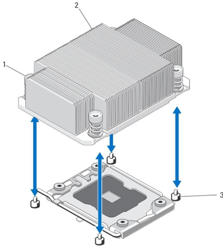
图 15: 卸下和安装散热器
