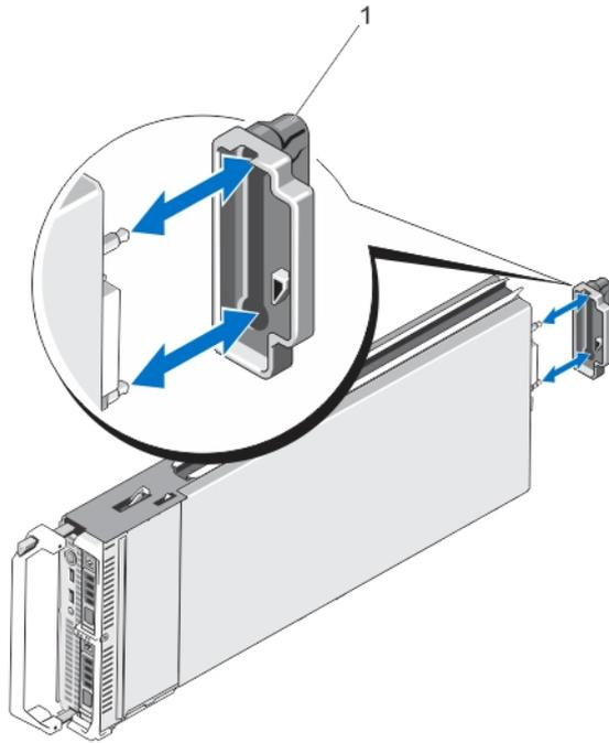
图 4: 卸下和安装 I/O 连接器护盖
