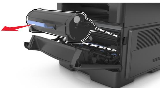
3 Levante la palanca azul y, a continuación, extraiga la unidad de imagen de la impresora.
