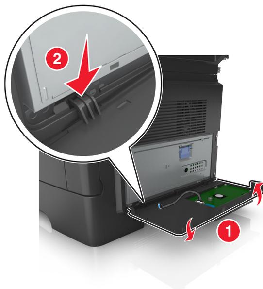
**10** Baje el resto de la cubierta y, a continuación, deslícela hacia la derecha.
