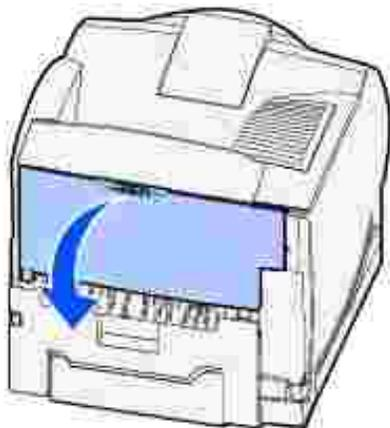
2. Extraiga el material de impresión según la parte que esté visible.
