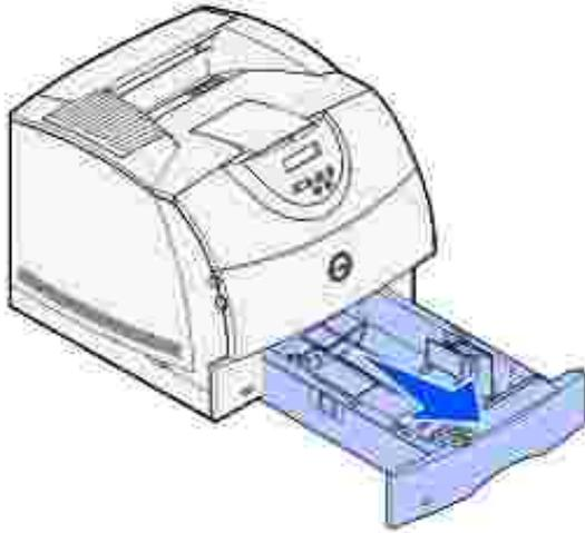
2. Presione la lengüeta de la guía de anchura y el lateral de la guía como se muestra. Deslice la guía hacia el extremo derecho de la bandeja.
