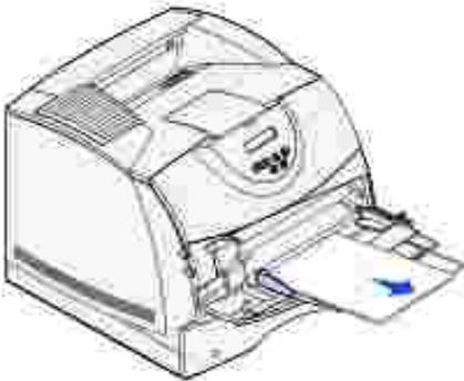
2. Empuje hacia adentro la barra metálica para introducir completamente el alimentador multiuso.
