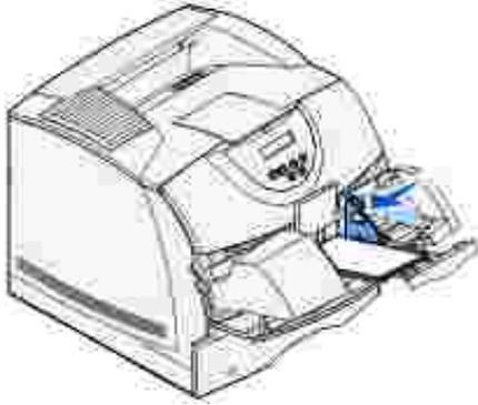
7. Baje el peso de sobres para que toque la pila.
