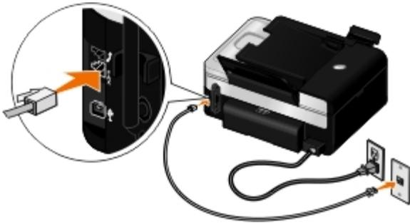
1. Conecte uma extremidade do cabo de telefone no conector FAX (  $\begin{matrix} F \\ A \\ X \end{matrix}$  — conector inferior).
