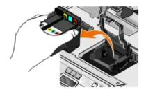
**Aviso—Dano Potencial:** Não toque no filtro de tinta do cabeçote de impressão nem nos orifícios do cabeçote de impressão.
